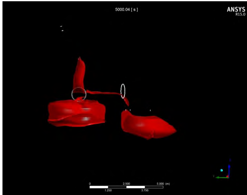
Abb. 4.32 IsoSurface mit Y_{H_2O} = 0.05 nach 5000 s bei der Simulation mit d = 200 \mu\text{m}
