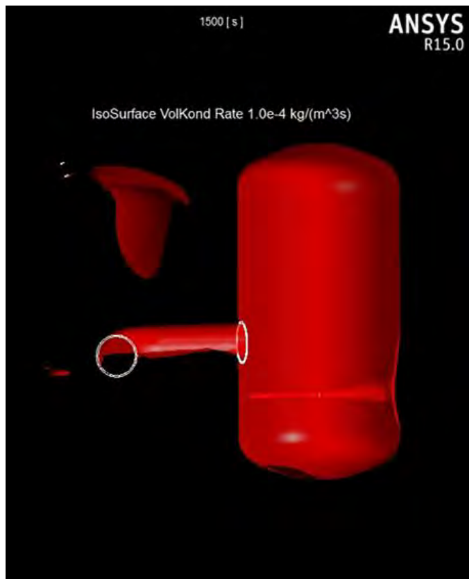
Abb. 4.16 Iso-Surface Volumenkondensationsrate = 1e-4 \text{ kg/ (m}^3\text{/s)} bei der Simulation mit Tröpfcheneinspeisung d200 zum Zeitpunkt t = 1500 \text{ s}
