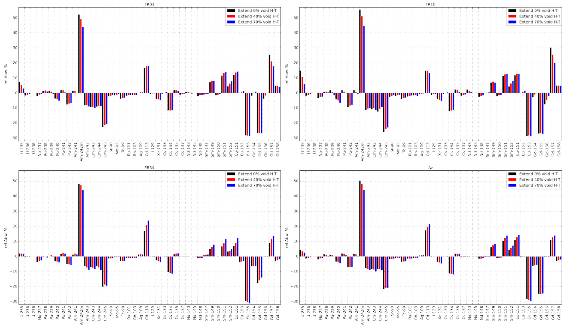
Abb. 2.3 Relative Abweichungen der Nuklidinventare der HELIOS von den TRITON Rechnungen bei 0 %, 40 %, und 70 % Dampfblasengehalt für die Brennstäbe FR03, FR10, FR34 und gemittelt über das gesamte Brennelement (Av).
