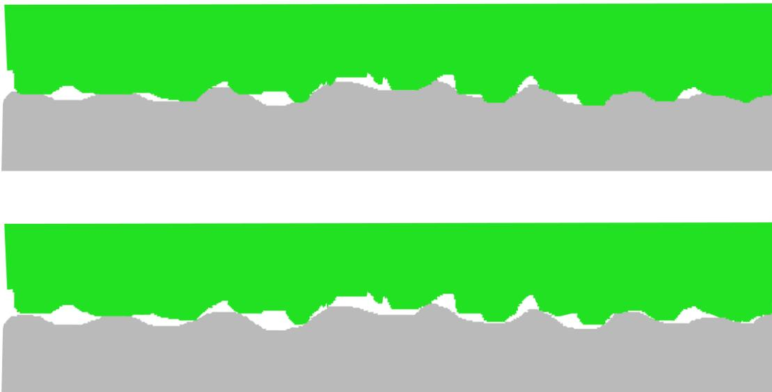
**Abb. 7.9** Schematische Darstellung des Kontakts zwischen Dichtung und Struktur bei vorgesehener Pressung (oben) und verminderter Pressung (unten)
