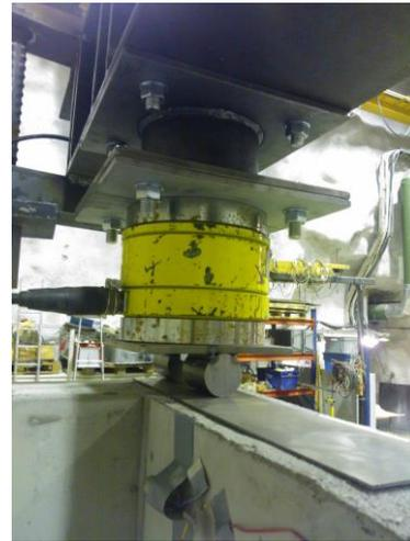
**Abb. 10.4** Lagerbedingung der oberen Kante der Frontseite in VTT-Versuch V1
