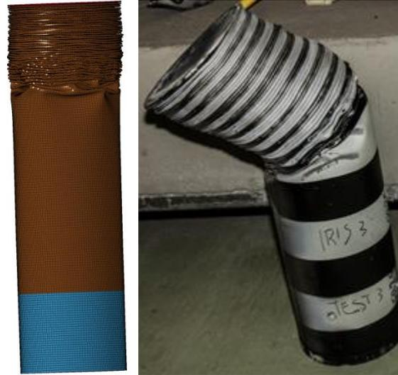
**Abb. 9.9** Verformungen der Projektile nach den IRIS-3-Versuchen
