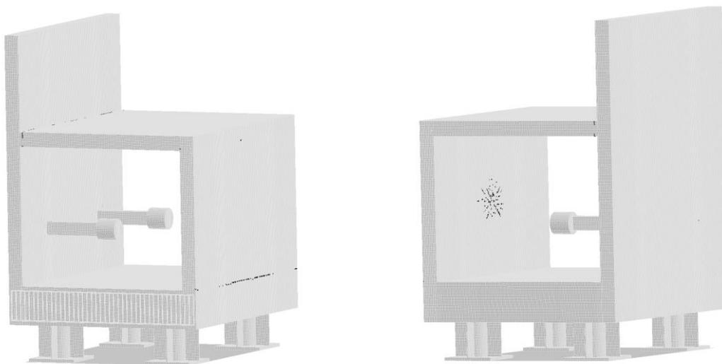
**Abb. 9.12** Visualisierung der Rissbildung in der Simulation zu IRIS-3 Va
