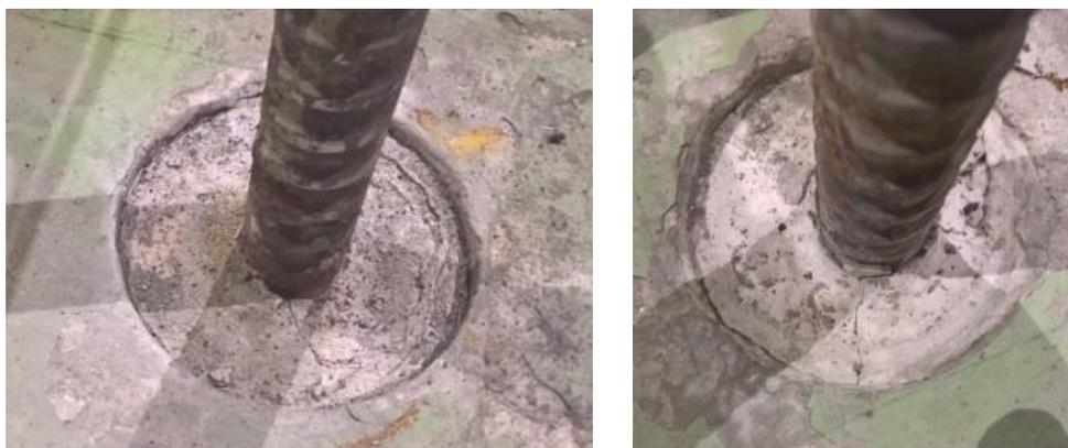
**Abb. 10.23** Risse des Vergussmaterials um die Verankerung nach VTT-Versuch V3
