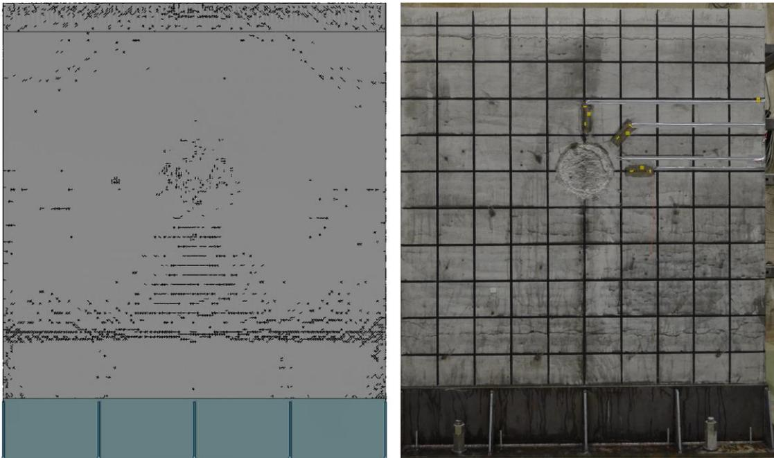
**Abb. 10.21** Rissbilder auf Frontseite der Frontwand nach VTT-Versuch V3 in der Simulation (links) und im Versuch (rechts)
