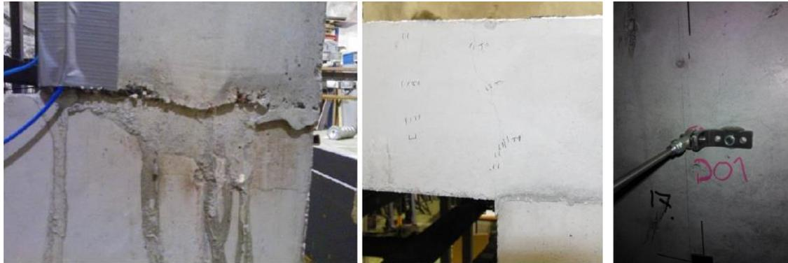
**Abb. 9.11** Rissbilder nach Versuch Va nahe der Verbindung von Front- und Bodenplatte (links), Frontplatte und Decke (mittig) sowie zentral auf Rückseite der Frontplatte (rechts)
