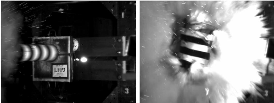
**Abb. 5.4** Hochgeschwindigkeitskameraaufnahmen des Projektils zu Aufprallbeginn und nach 9 ms in Versuch LFP3
