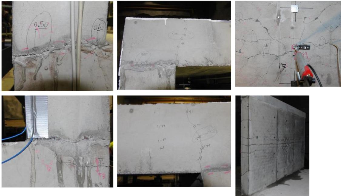
**Abb. 9.13** Rissbilder nach Versuch Vc nahe der Verbindung von Front- und Bodenplatte (links), Frontplatte und Decke (mittig) sowie zentral auf Rückseite der Frontplatte (rechts)
