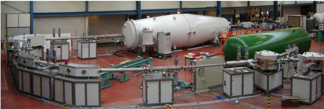
**Abb. 3.3** 6 MV AMS-Beschleuniger, wie er für die Messungen im Rahmen des Projektes eingesetzt wurde
