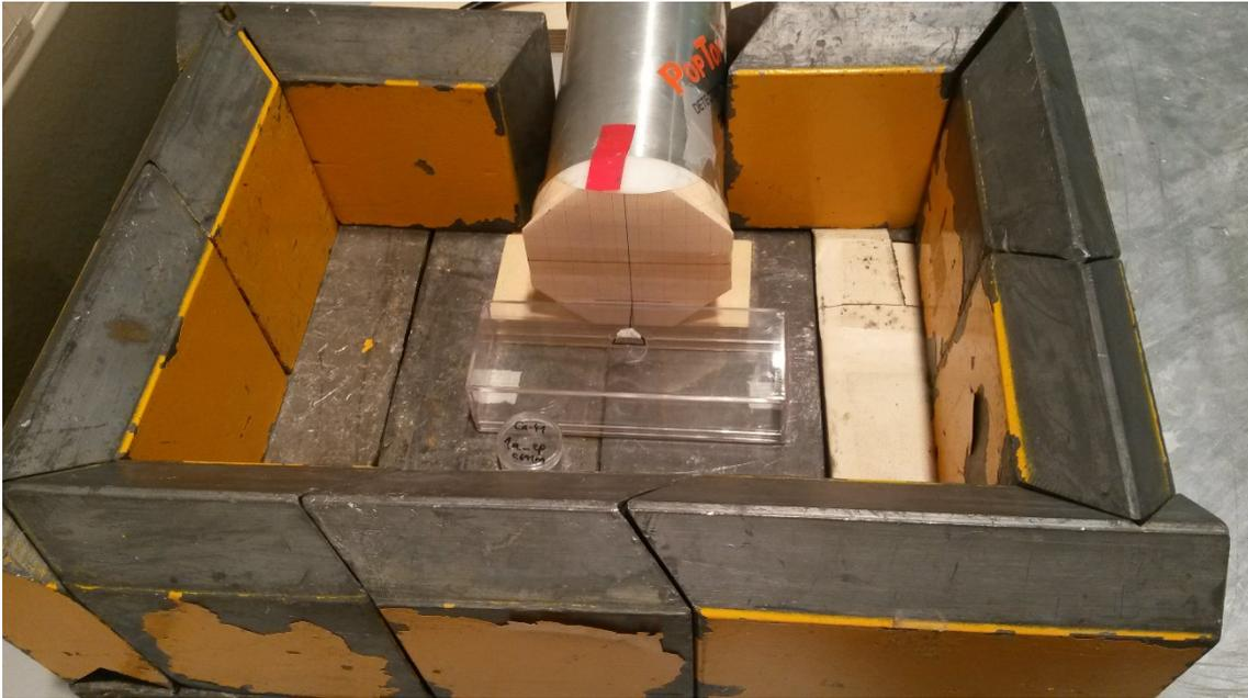
**Abb. 4.7** Messplatz für gammaspektrometrische Untersuchungen der Betonproben
