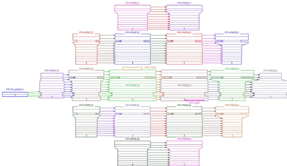
**Abb. 2.9** 3D-Nodalisierung des INKA Flutbeckens mit Querverbindungen
