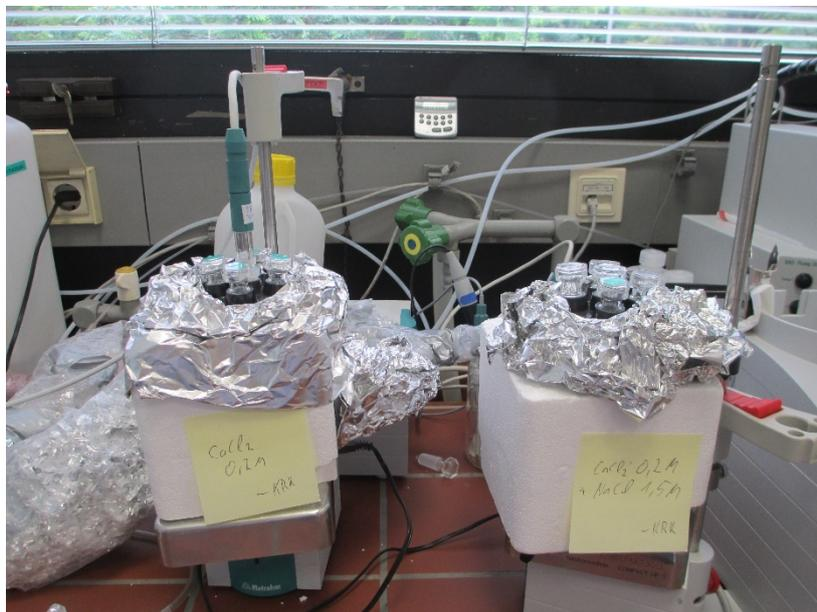
**Abb. 6.6** Messungen zur Ermittlung des Zusammenhanges Salzfracht, pH und Temperatur mit einer Glaselektrode für den Temperaturbereich 20 - 90 °C
