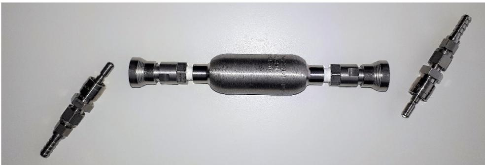
**Abb. 6.63** Druckfestes Probenahmegefäß mit Schnellkupplungen
