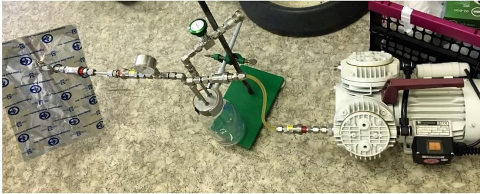
**Abb. 6.82** Vorrichtung zur Beprobung der Thermalwassergasphase
