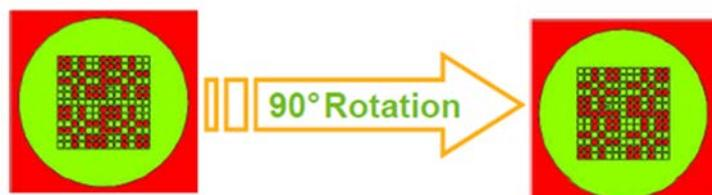
**Abb. 6.86** Das „Maske – Anti-Maske“ Prinzip einer „Coded Mask“-Blende der GAMPIX Kamera von Canberra: Maske = Signal + Hintergrund, Anti-Maske ( $90^\circ$ ) = Hintergrund /MAH 11/, /CAR 11/
