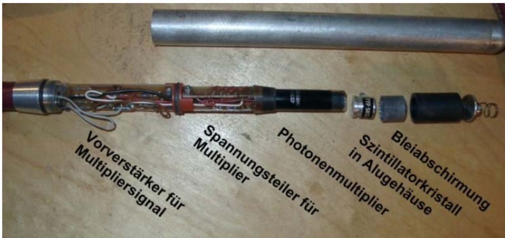
**Abb. 6.122** Messkopf einer geöffneten Bohrlochsonde (Unirad) /KRU 11/
