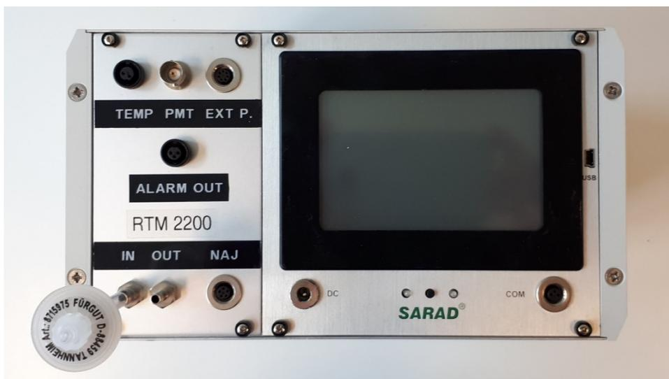
**Abb. 6.45** Frontansicht des Alphaspektroskopie-Moduls
