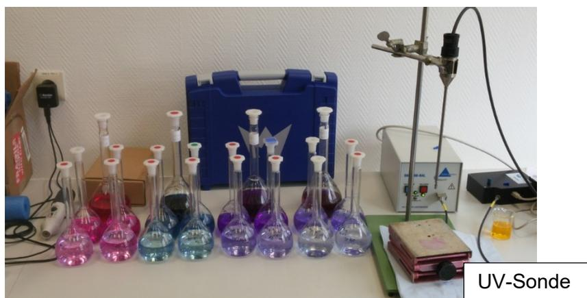
**Abb. 6.15** Vorversuche zur Bestimmung des optimalen Konzentrationsbereiches der H<sup>+</sup>-Indikatoren
