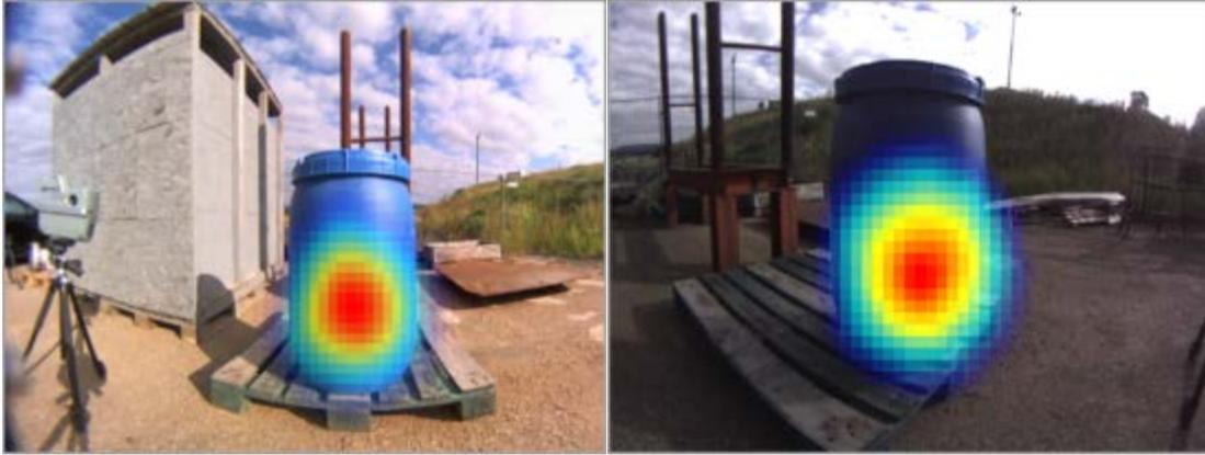
**Abb. 6.99** Polaris-H (l)/Apollo (r): Die überlagerten Gamma-Bilder vom Fass Rückstände (Objekt 13)
