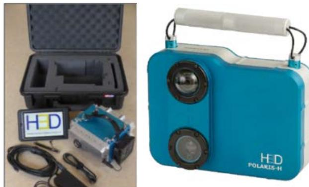
**Abb. 6.93** Gamma-Ray Imaging Spektrometer „Polaris-H“ der US-Firma H3D; (links: Modell 2016, rechts: Modell 2017) /H3D 16/
