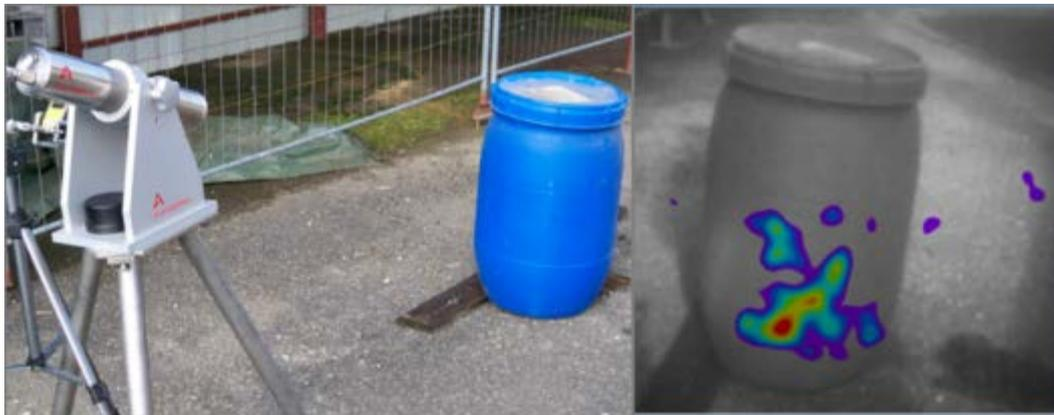
**Abb. 6.97** Cartogam: Fass Rückstände (Objekt 13), Fass mit hoher ODL zur Kamera (rechts das überlagerte Gamma-Bild)
