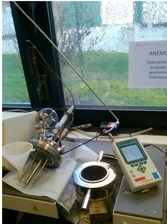
**Abb. 6.1** Druckreaktor auf speziellem Laborwagen mit abgenommenem Deckel und eingebauten Elektroden
