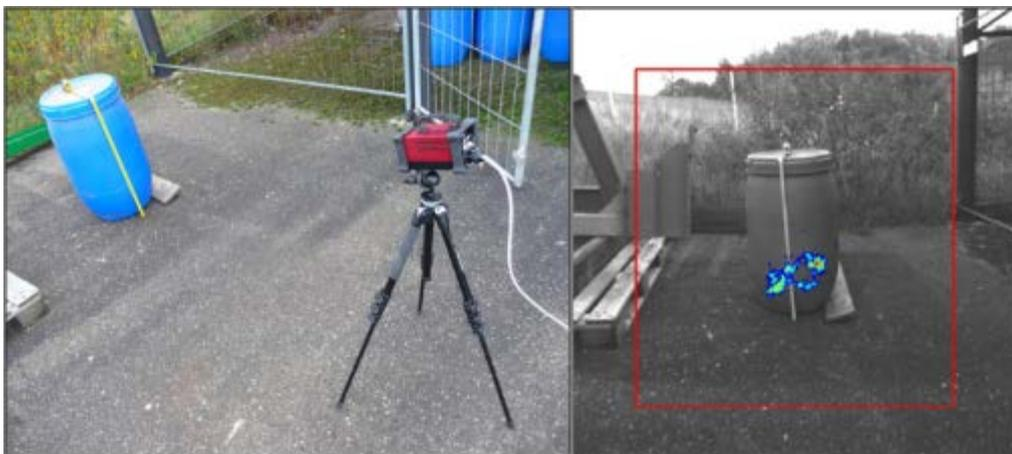
**Abb. 6.96** iPIX: Fass Rückstände, Fass um 180° gedreht mit hoher ODL zur Kamera (rechts das überlagerte Gamma-Bild) – der rote Rahmen zeigt das Gamma-Sichtfeld
