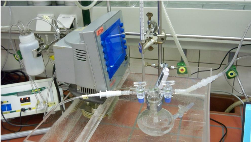
**Abb. 6.73** Die thermostatierte Gleichgewichtseinstellung zwischen Gasphase und wässriger salinärer Phase im Luftstrom mit einer definierten Radon-Aktivitätskonzentration
