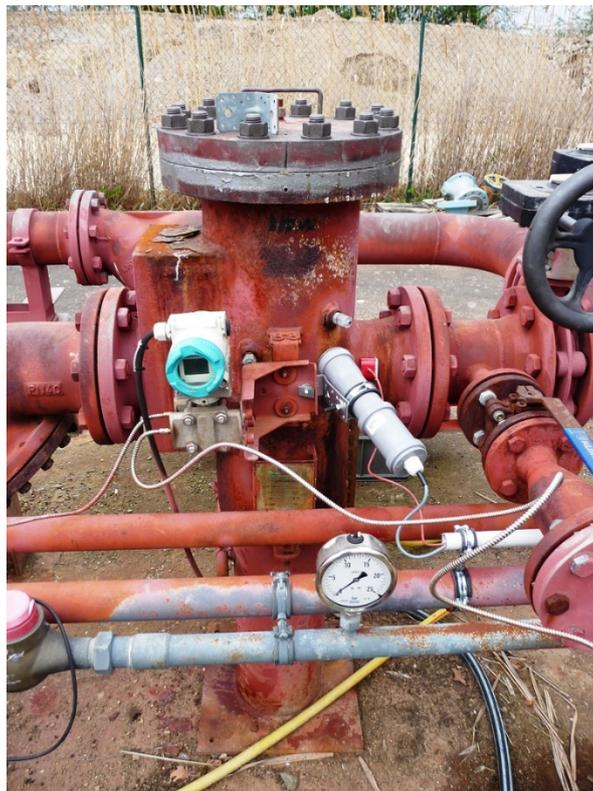
**Abb. 6.153** Positionierung des CdZnTe-Detektors Konto 3 am Filter der Reinjektionsleitung
