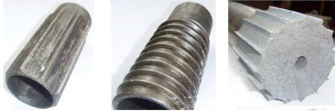
**Abb. 6.168** Dekontaminationswerkzeug mit Kantengeometrie /BÖS 11/
