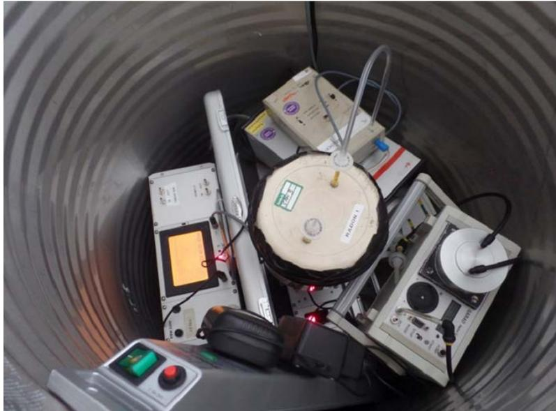
**Abb. 6.57** Edelstahlfass mit exponierten Radonmonitoren, CO<sub>2</sub>-Mesgeräten und Rn-Exhalationsquelle. Nicht sichtbar: Ventilator
