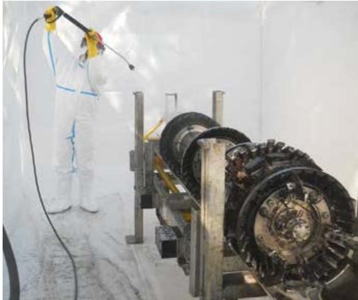
**Abb. 6.166** Hochdruckwasserstrahlverfahren /ZAM 14/
