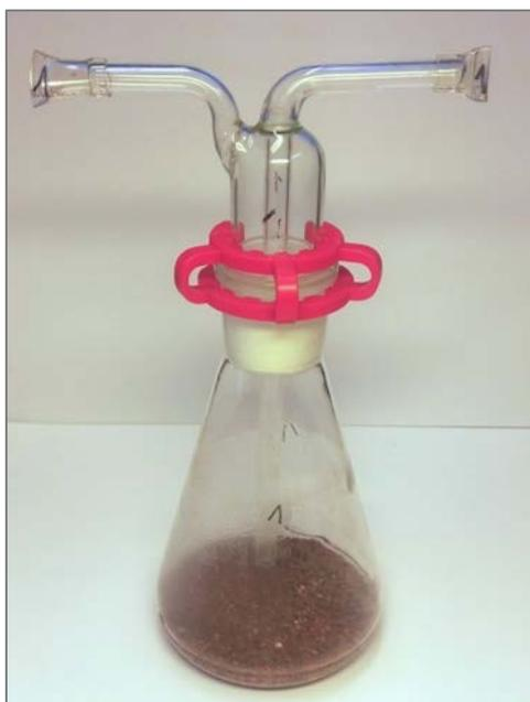
**Abb. 6.68** Radondicht verschlossene Emanationskammer
