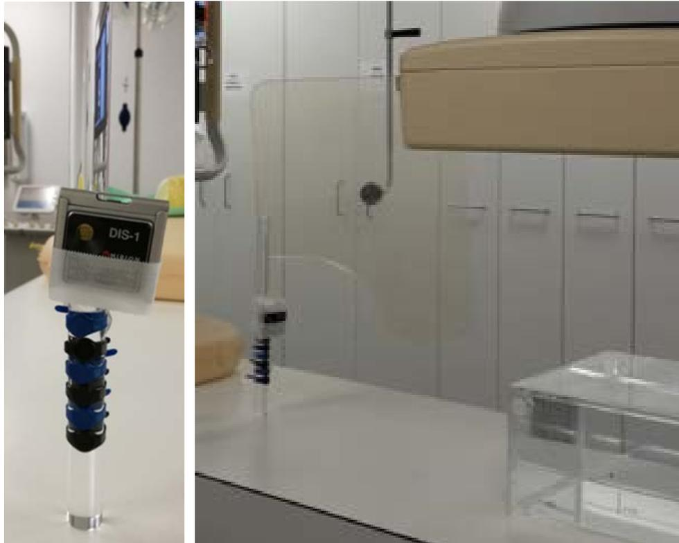
**Abb. 5.11** Links: Fingerphantom mit abwechselnd TLD-Ringdosimetern (blau) und OSL-Ringdosimetern (schwarz) bestückt. Zuoberst befindet sich ein Dis-1 Dosimeter. Rechts: Das Fingerphantom wurde in ca. 50 cm Abstand zum Streukörper gestellt
