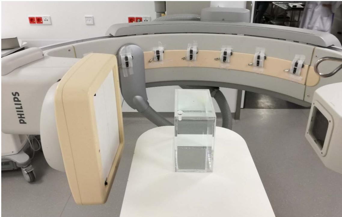
**Abb. 5.8** Experimenteller Aufbau zur Messung der durch die Streustrahlung verursachten Dosis bei 90° RAO Angulation des C-Bogens
