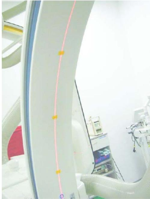
**Abb. 5.3** Drei der mit dem selbstnivellierendem Laserkreuz bestimmten Messpositionen im C-Bogen (gelbe Markierungen)
