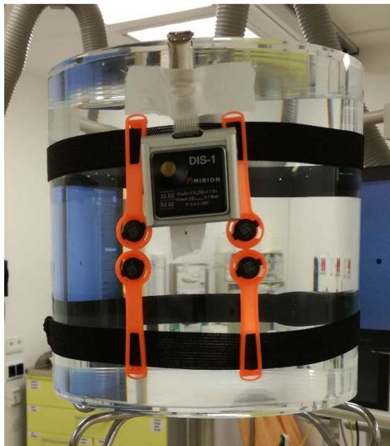
**Abb. 5.9** Bestückung des Kopfphantoms mit ALD und Dis-1 Dosimetern
