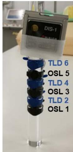
**Abb. 7.20** Dosimeterkonfiguration an dem Fingerphantom. Es wechseln sich von unten nach oben OSL Ringe (schwarz) mit TLD-Ringen (blau) ab. Als oberstes wurde das Dis-1 Dosimeter montiert
