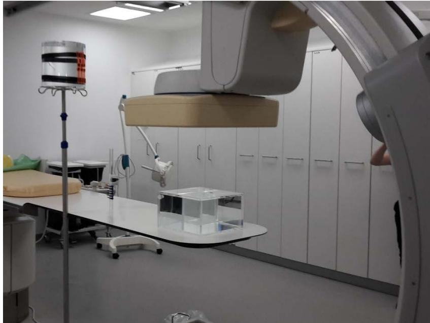
**Abb. 5.10** Positionierung des Kopfphantoms (links oben) im Raum. Die Dosimeter sind in Richtung des C-Bogens/Streukörper ausgerichtet
