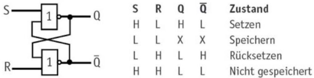
Abb. 3.7 Aufbau einer bistabilen Kippstufe (Flipflop) aus Logikgattern links, zugehörige Wahrheitstabelle rechts (H: High, L: Low) /ELV 19/
