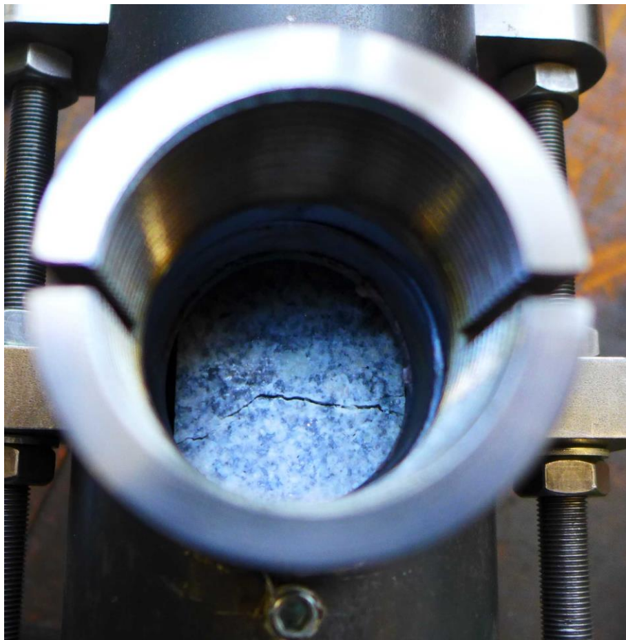
Abb. 5.6 Blick durch das Zulauf-Anschlussrohrstück auf die gerissene Oberfläche des Probekörpers /ZEM 17b/
