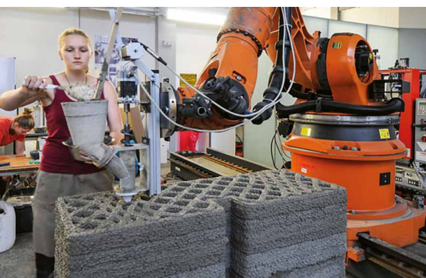
Additive Fertigung durch Extrusion von Holzleichtbeton, Forschungsprojekt des Lehrstuhls für Holzbau und Baukonstruktion, TU München. © Florian Säger
