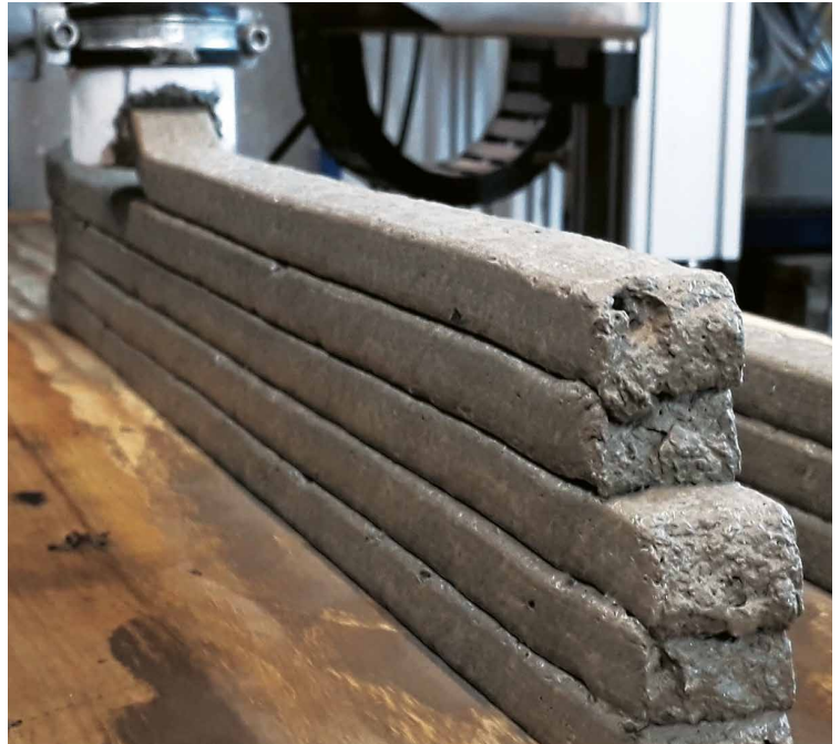
3D-gedruckte Schaumbetonwand © CONPrint3D-Ultralight – TU Dresden
