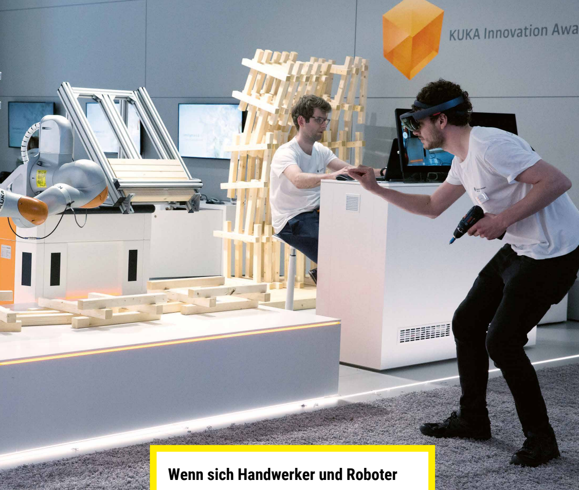
Interaktive Steuerungsumgebung mit kollaborativem Roboter und Augmented Reality (AR) Headset. © ICD Universität Stuttgart
