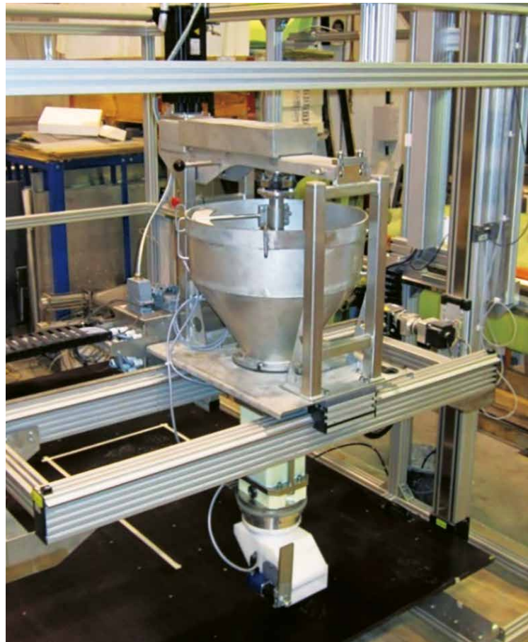
Zwischenvorratsbehälter und Druckkopf des CONPrint3D®-Beton-3D-Druckers © CONPrint3D-Ultralight – TU Dresden
