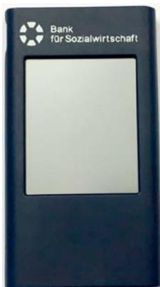
Der photoTAN-Token hat einen Touchscreen und ist mit einem Akku ausgestattet. Dieser kann mittels dem beiliegenden USB-Kabel an ein handelsübliches USB-Ladegerät bzw. an einen aktiven USB-Port (stromversorgt) eines Computers zum Laden angeschlossen werden.
