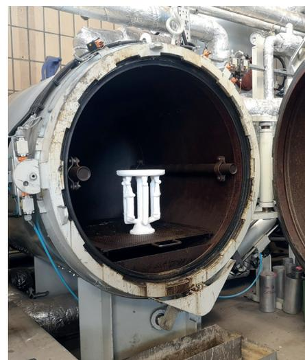
Dampfautoklav zur Untersuchung des Ausschmelzverhaltens von Wachsmodellen
