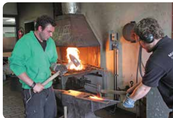
Herstellung eines geschmiedeten Geländers (Metallgestalter)
