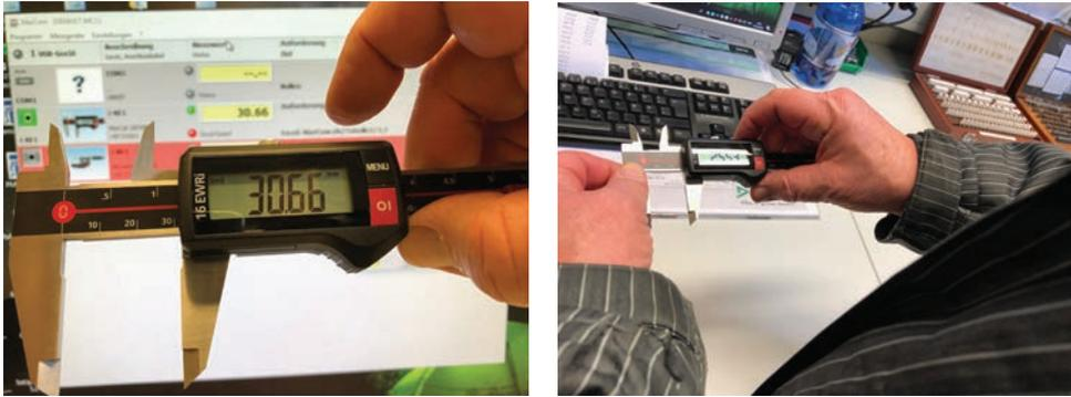
**Abb. 12:** Messschieber mit WLAN- und Bluetooth-Übertragungsmöglichkeit
