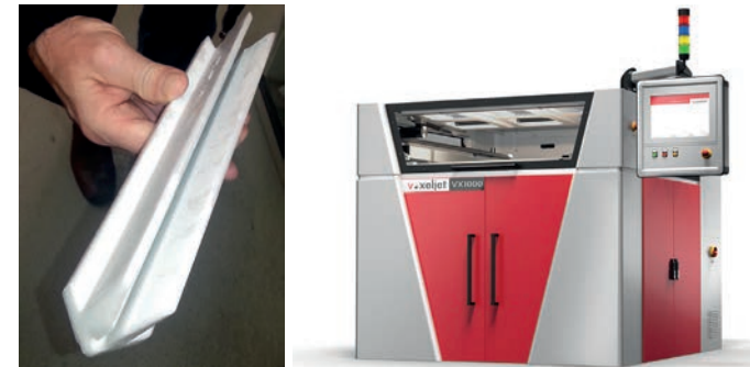
Abb. 17: 3D-Druck mit Gussformteil
