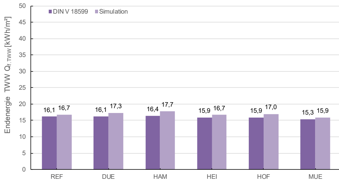
Abbildung 99: Endenergie Trinkwarmwasser – Vergleich Monatsbilanzverfahren und Simulation (M_STW)
