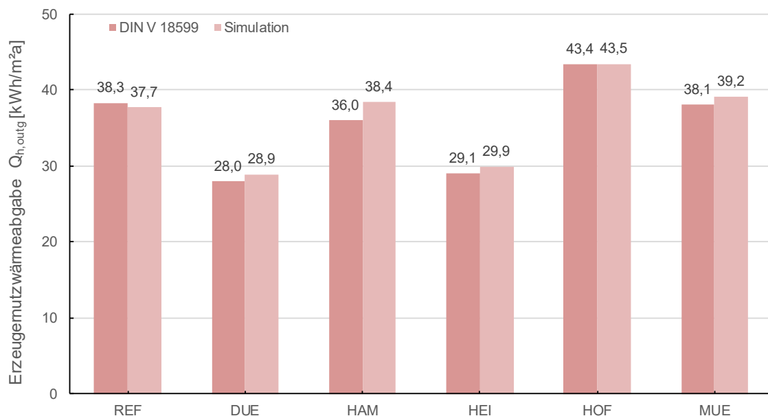
Abbildung 93: Erzeugernutzwärme Heizung – Vergleich Monatsbilanzverfahren und Simulation (M_BWS)
