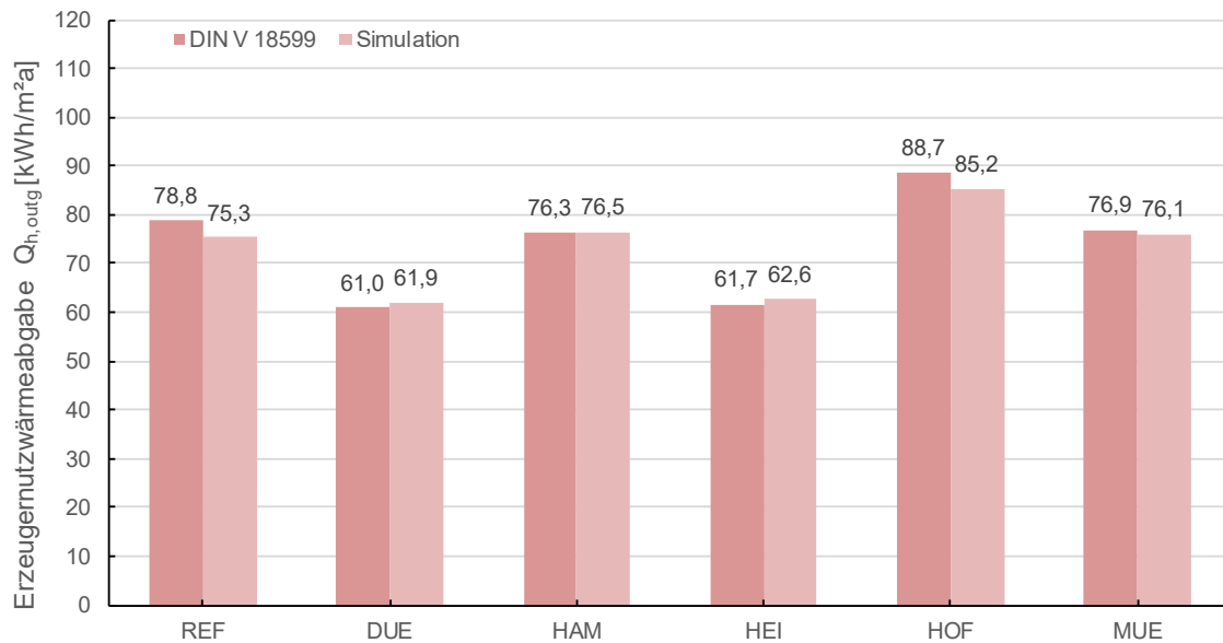
Abbildung 104: Erzeugernutzwärme Heizung – Vergleich Monatsbilanzverfahren und Simulation (B_BWL)
