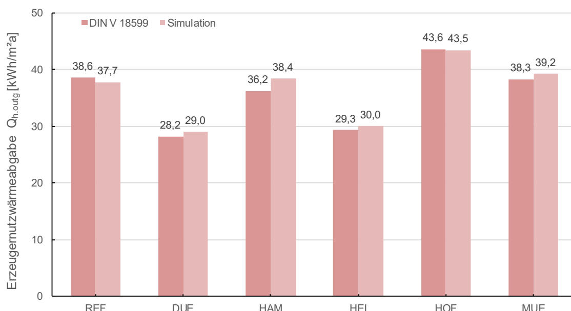
Abbildung 91: Erzeugernutzwärme Heizung – Vergleich Monatsbilanzverfahren und Simulation (M_0)
