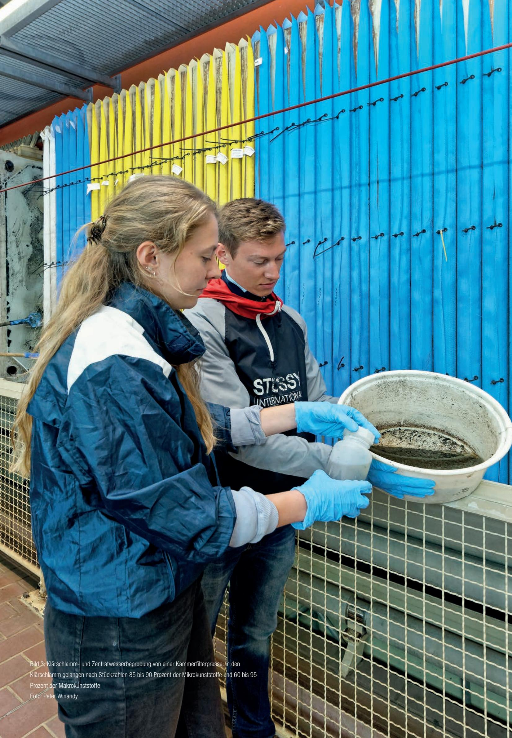
Bild 3: Klärschlamm- und Zentratwasserbeprobung von einer Kammerfilterpresse: in den Klärschlamm gelangen nach Stückzahlen 85 bis 90 Prozent der Mikroplaststoffe und 60 bis 95 Prozent der Makroplaststoffe
