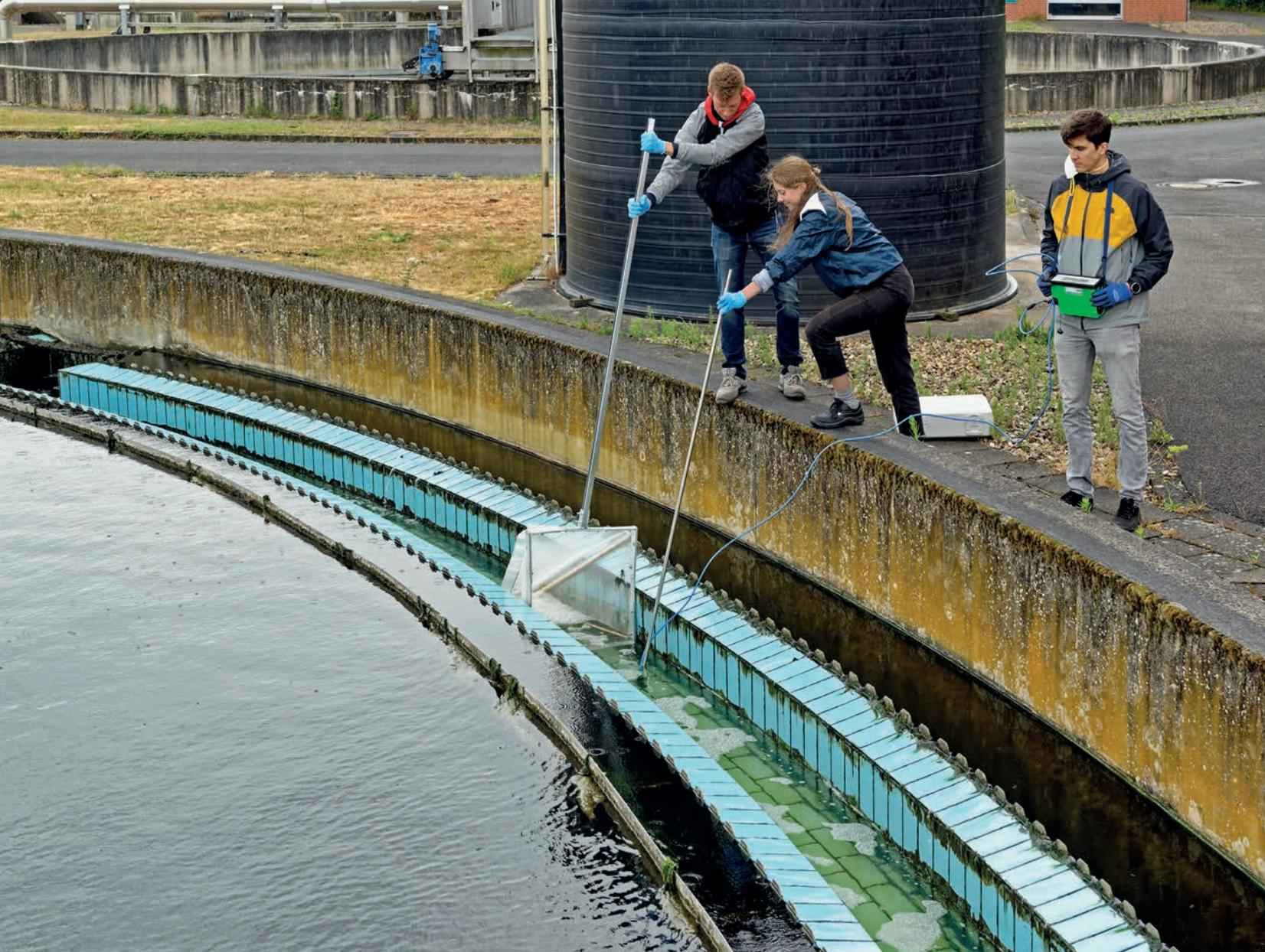
Bild 4: Probenahme im Ablauf eines Nachklärbeckens
