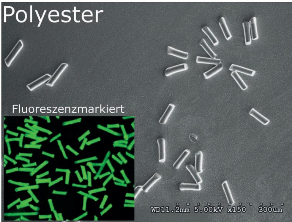
Bild 3: Faseriges Modellmikroplastik mit 55  $\mu\text{m}$  Länge aus Nylon-6 (oben) und Polyester (unten) sowie die fluoreszenzmarkierten Partikel (eingefügt)
