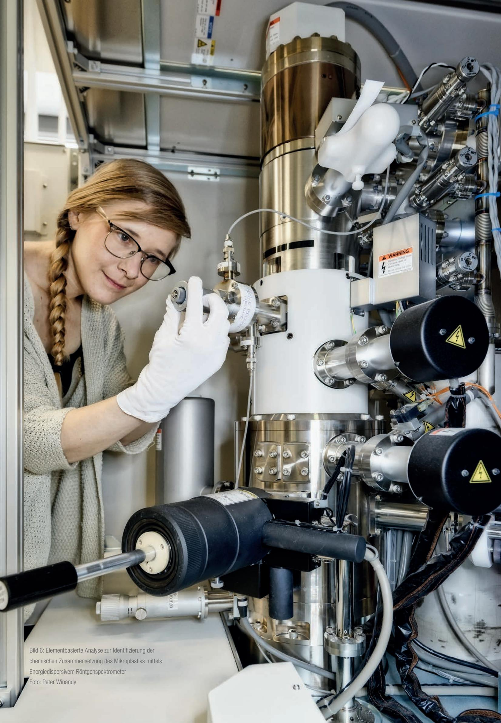
Bild 6: Elementbasierte Analyse zur Identifizierung der chemischen Zusammensetzung des Mikroplastiks mittels Energiedispersivem Röntgenspektrometer
