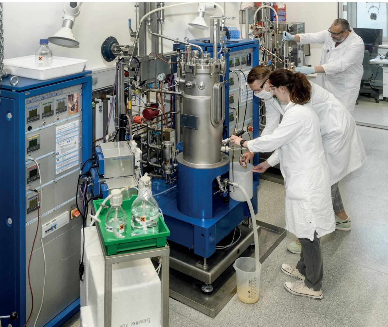
Bild 1: Fermentation zur Herstellung von Enzymen für die Degradation von Mikroplastik in Bestandteile niedrigerer Molmasse.
