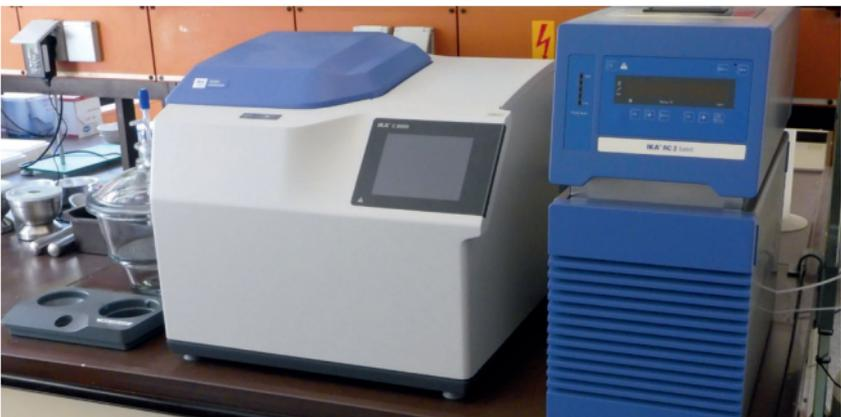
Kalorimeter (PCS-Apparatur) zur Bestimmung der Bruttoverbrennungswärme
