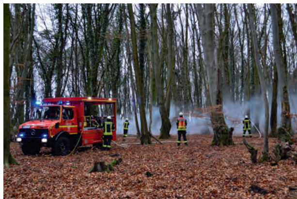
Mit der Beladung für Vegetationsbrände und 1700l Löschwassertank ist das Fahrzeug bestens gerüstet für die immer häufiger auftretenden Wald- und Vegetationsbrände.
