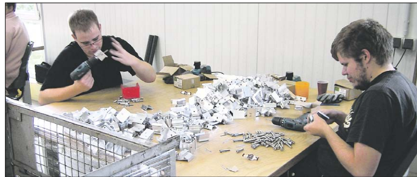
Die Mitarbeiter Michael Annegarn (li.) und David Cross verschrauben ein Halbfertigteil zu einer Einheit. Dies wird zum Festklemmen der Solarmodule benötigt. Foto: Rahmer
