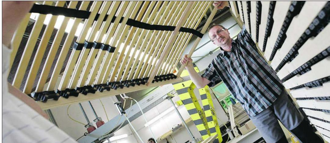
Matratzenrahmen werden von den Lübbecker Werkstätten für mehrere Unternehmen aus der Region produziert. Mithilfe moderner Maschinen werden die Sperrholzplatten für die Rahmen zugeschnitten, Profile gefräst und Löcher gebohrt. Fotos (2): Hendrick Schmalhorst
