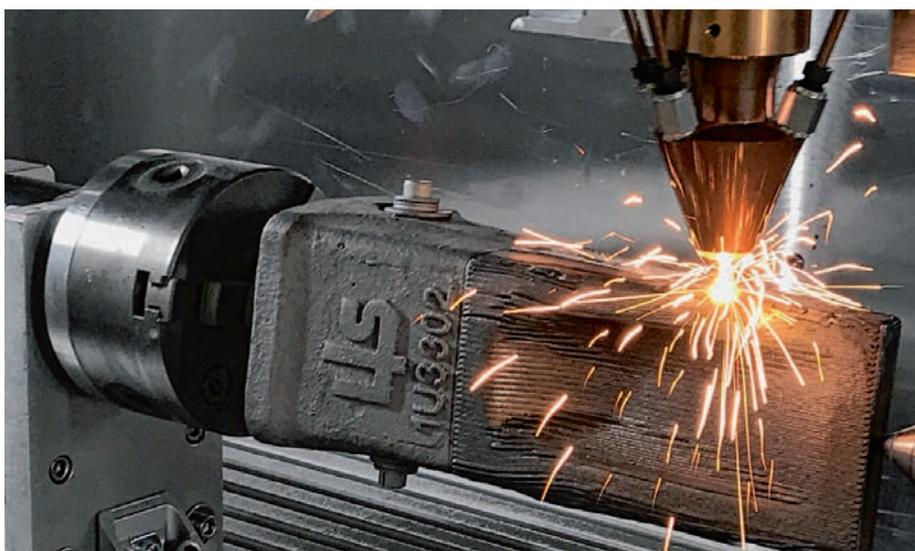
Das Technologieunternehmen Lunovu ist spezialisiert auf die Entwicklung und Vermarktung von intelligenten und vernetzten Maschinen für das Laser-Metal-Deposition-Verfahren – eine disruptive Technologie im Bereich des 3D-Metalldrucks.
