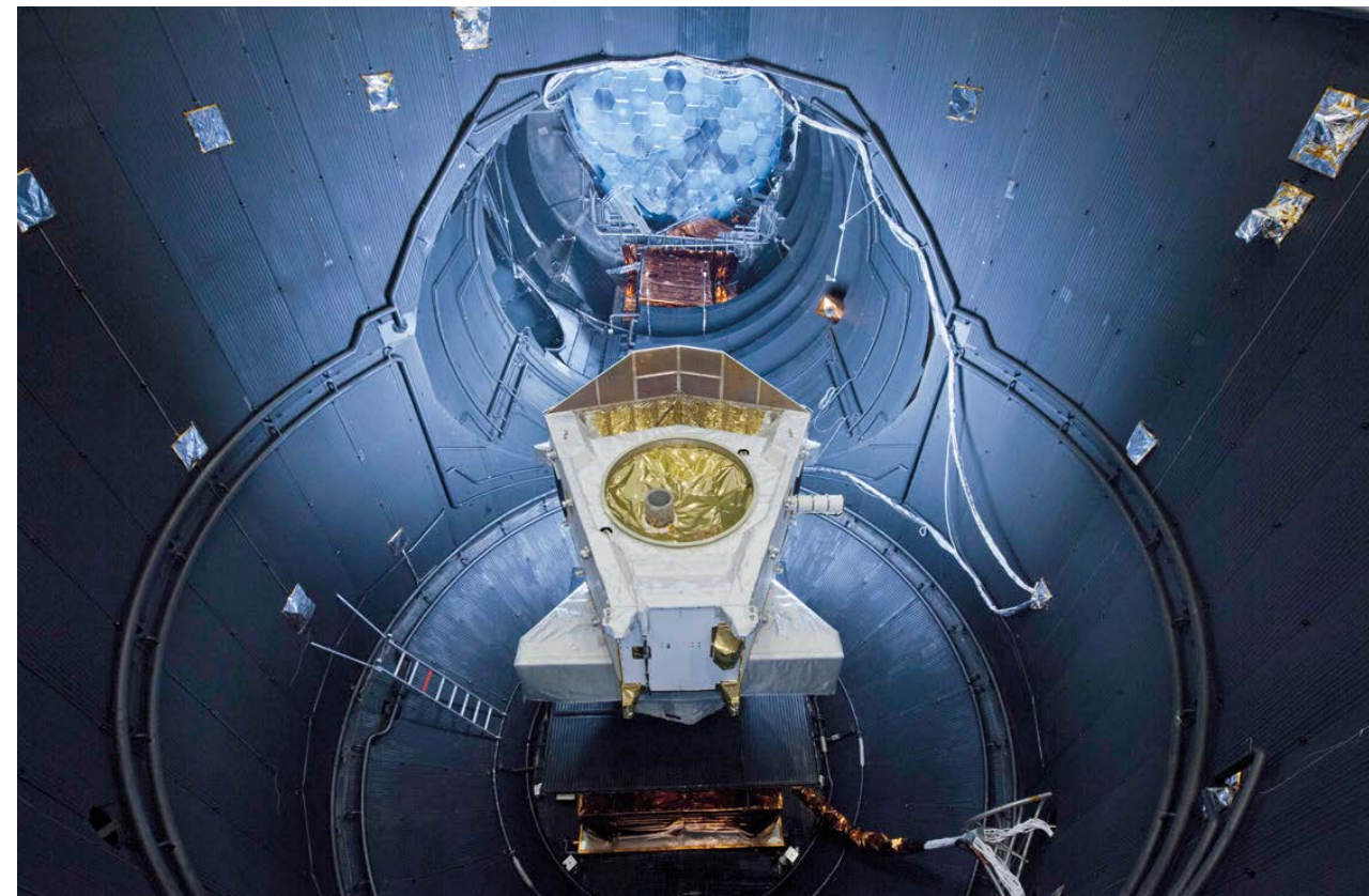
Heiße Zeit für BepiColombo: Das Ingenieurmodell des europäischen Merkur-Transfermoduls wurde im Large Space Simulator des Testzentrums ESTEC der europäischen Weltraumagentur ESA im niederländischen Noordwijk auf Herz und Nieren geprüft. Dort erhielt BepiColombo unter anderem einen "Vorgeschmack" auf die extreme Sonnenhitze, der es 2024 in der Umlaufbahn des sonnennächsten Planeten ausgesetzt sein wird. Der Test im Vakuum lief ununterbrochen zwölf Tage lang. In dieser Zeit war das Modul einer zehnfach höheren Sonnenstrahlung als ein Satellit in der Erdumlaufbahn ausgesetzt.
