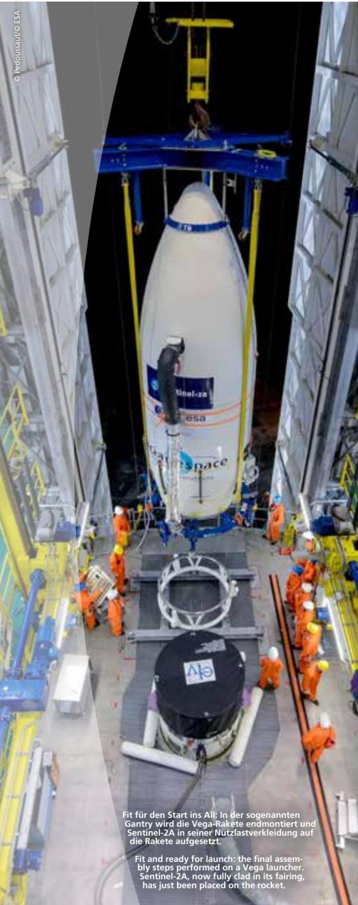
Fit für den Start ins All: In der sogenannten Gantry wird die Vega-Rakete endmontiert und Sentinel-2A in seiner Nutzlastverkleidung auf die Rakete aufgesetzt.
