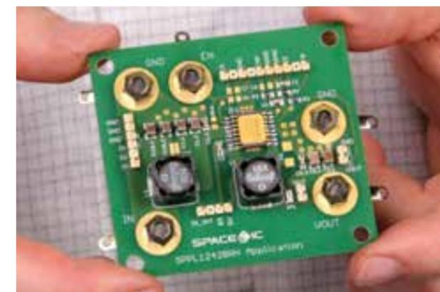
Integrierter Winzling: Der elektronische Schaltkreis SPPL12420RH ist zentral in diese Demonstrationsplatine eingebaut. Damit lässt sich die Funktion des Bausteins in einer praktischen Anwendung zeigen.
