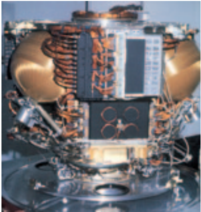
Unverschlossene Hauptinstrumente: Im Vordergrund ist die PSPC-Kamera zu sehen. Das Gas für den Betrieb der Kamera wurde in zwei gelben Tanks an der Seite aufbewahrt. Das Gas ging Ende 1993 zur Neige woraufhin nur noch die High-Resolution Imager (HRI) Kamera genutzt werden konnte. Mit ihr konnten hochauflösende schwarz-weiß Röntgenaufnahmen gemacht werden.
