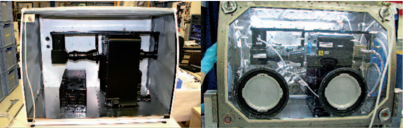
Im Mission Control Center in Huntsville wurde eine zweite CCF Experimenteinheit in einem Modell der Microgravity Science Glovebox installiert. Diese zweite Einheit erlaubt Wissenschaftlern und Ingenieuren vom Boden aus Versuchsszenarien zu simulieren. (NASA)
