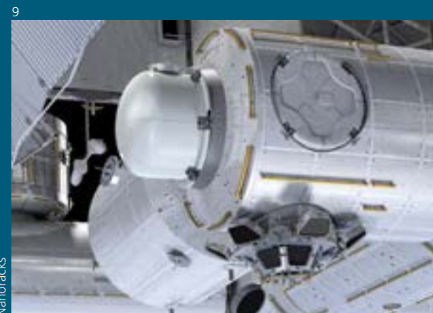
Oben: Mit der kommerziellen Raumfahrt ändert sich auch das Gesicht der Raumstation. Die US-amerikanische Außenplattform MUSES (7) der Firma Teledyne Brown Engineering ist die erste ihrer Art. Das DLR-Erdbeobachtungsinstrument DESIS ist hier untergebracht. Das BEAM (8) der US-Firma Bigelow ist das erste private, entfaltbare Raumstationsmodul. Hier können Astronauten wie Alexander Gerst (hinten links) Material verstauen. Ab Juni 2020 kommt mit dem Bishop Airlock (9) der US-Firma Nanoracks die erste kommerzielle Luftschleuse hinzu. Ab 2024 werden neue Großmodule der US-Firma Axiom Space die ISS erweitern. Die Module werden später in eine eigene Raumstation (10) umgewandelt, die von der ISS losgelöst alleine um die Erde kreisen wird.
