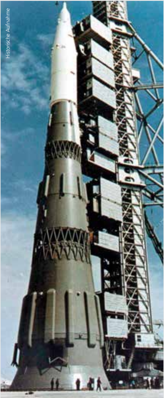
Ein sowjetischer „Gigant“: 105,3 Meter hoch, 22,4 Meter breit, 2.825 Tonnen Gesamtmasse, 23,5 Tonnen maximale Nutzlast zum Mond, rund 45.900 Kilonewton Schub. Die 5-stufige N1 sollte die Sowjetunion zum Mond bringen. Nach vier Fehlstarts und dem Erfolg des US-amerikanischen Apollo-Programms wurden die kosmonautischen sowjetischen Mondpläne allerdings eingestellt.
