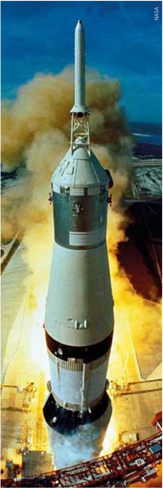
Ein amerikanischer „Gigant“: 110,6 Meter hoch, 10,06 Meter breit, 2.934,8 Tonnen Gesamtgewicht, 48,6 Tonnen maximale Nutzlast zum Mond, 33.851 Kilonewton Schub. Die dreistufige Saturn V – hier beim Apollo-11-Start – war der Garant des erfolgreichen Mondprogramms.
