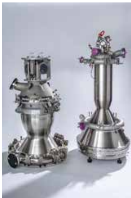
Vulcain- und Vinci-Schubkammern aus Ottobrunn sind das Herzstück für das Haupt- und Oberstufen-triebwerk der Ariane 6
