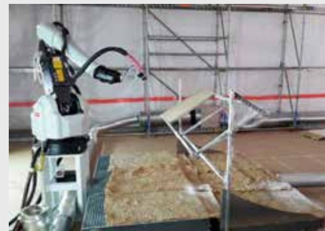
Durchführung von Schaum-Sprühtests zur Optimierung der Aufsprühposition bei der Anwendung des Sprühprozesses auf die späteren Raketenstrukturen der Ariane 6, hier durchgeführt im Rahmen des FLPP
