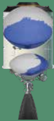
Vereinfachte Darstellung des Treibstoffschwappens in den Treibstofftanks der Ariane-6-Oberstufe während der ballistischen/nicht angetriebenen Flugphase Simplified visualisation of propellant sloshing in the propellant tanks of the Ariane 6 upper stage during the ballistic/non-propulsive flight phase.
