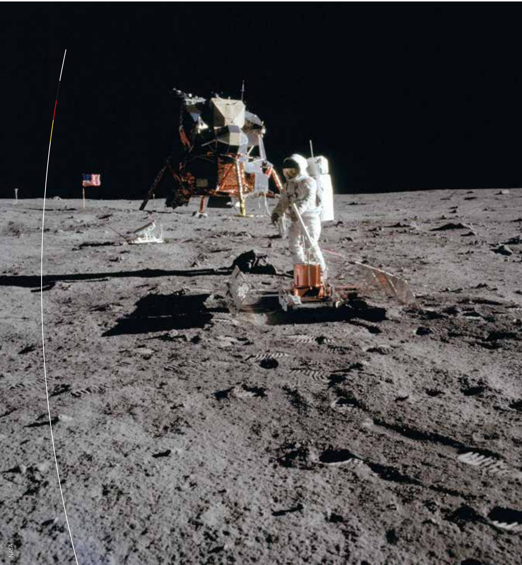
Apollo-11-Astronaut Buzz Aldrin baut am 21. Juli 1969 das Early Apollo Scientific Experiments Package (EASEP) auf. Mit dazu gehören auch das Passive Seismic Experiments Package (PSEP) und der Laser Ranging Retroreflector LR-3. Apollo 11 astronaut Buzz Aldrin sets up the Early Apollo Scientific Experiments Package (EASEP) on July 21, 1969. It includes the Passive Seismic Experiments Package (PSEP) and the Laser Ranging Retroreflector LR-3.
