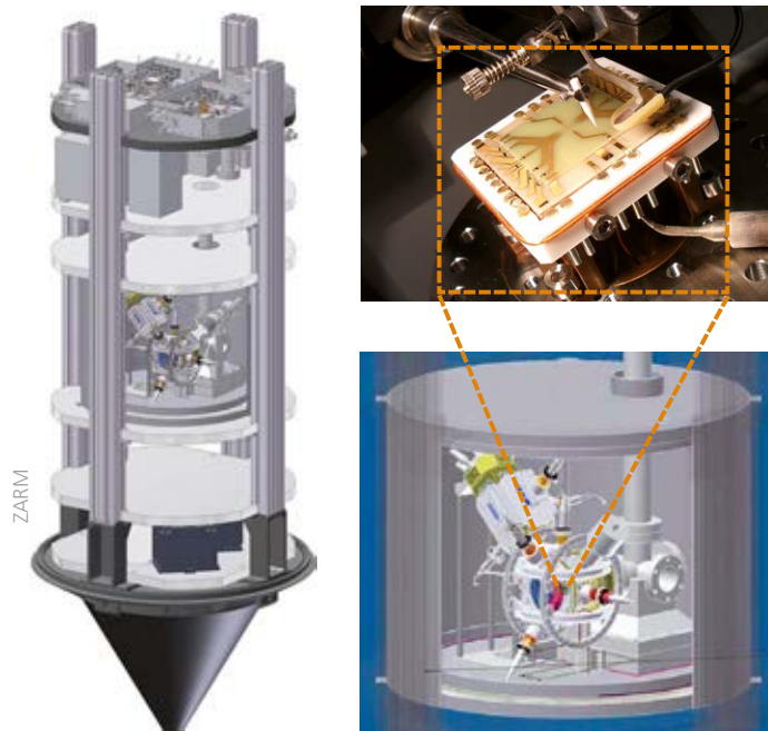
High-tech im Miniaturformat: Die QUANTUS-Apparatur passt in eine zwei Meter hohe und 82 Zentimeter durchmessende Fallturmkapsel (l.). Auf dem Atomchip (rotes Kreuz, m. und r.) im Herzen der Apparatur sind die Atome für den Versuch „gespeichert“.
