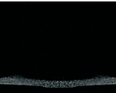
Unter den Bedingungen der Schwerkraft sammeln sich die Partikel im unteren Bereich, der entstandene Plasmakristall ist gestaucht Under terrestrial gravity conditions the particles occupy the lowest possible area. Such a plasma crystal is "stressed"
