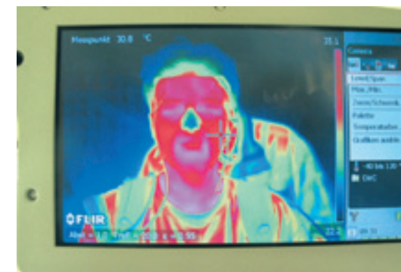
Kopf einer Testperson, aufgenommen mit einer Wärmebildkamera (rot = warm, blau = kalt) Head of a test subject recorded by a thermal imaging camera (red = warm, blue = cold)
