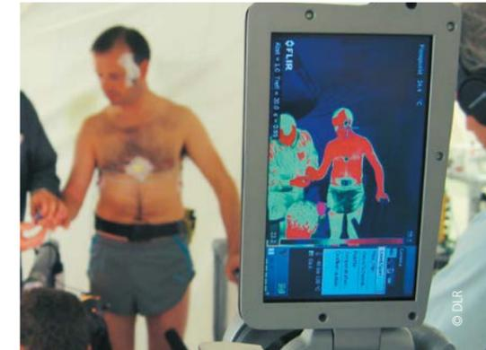
Wärmebildkamera dokumentiert die Wärmeverteilung bei einer Testperson
