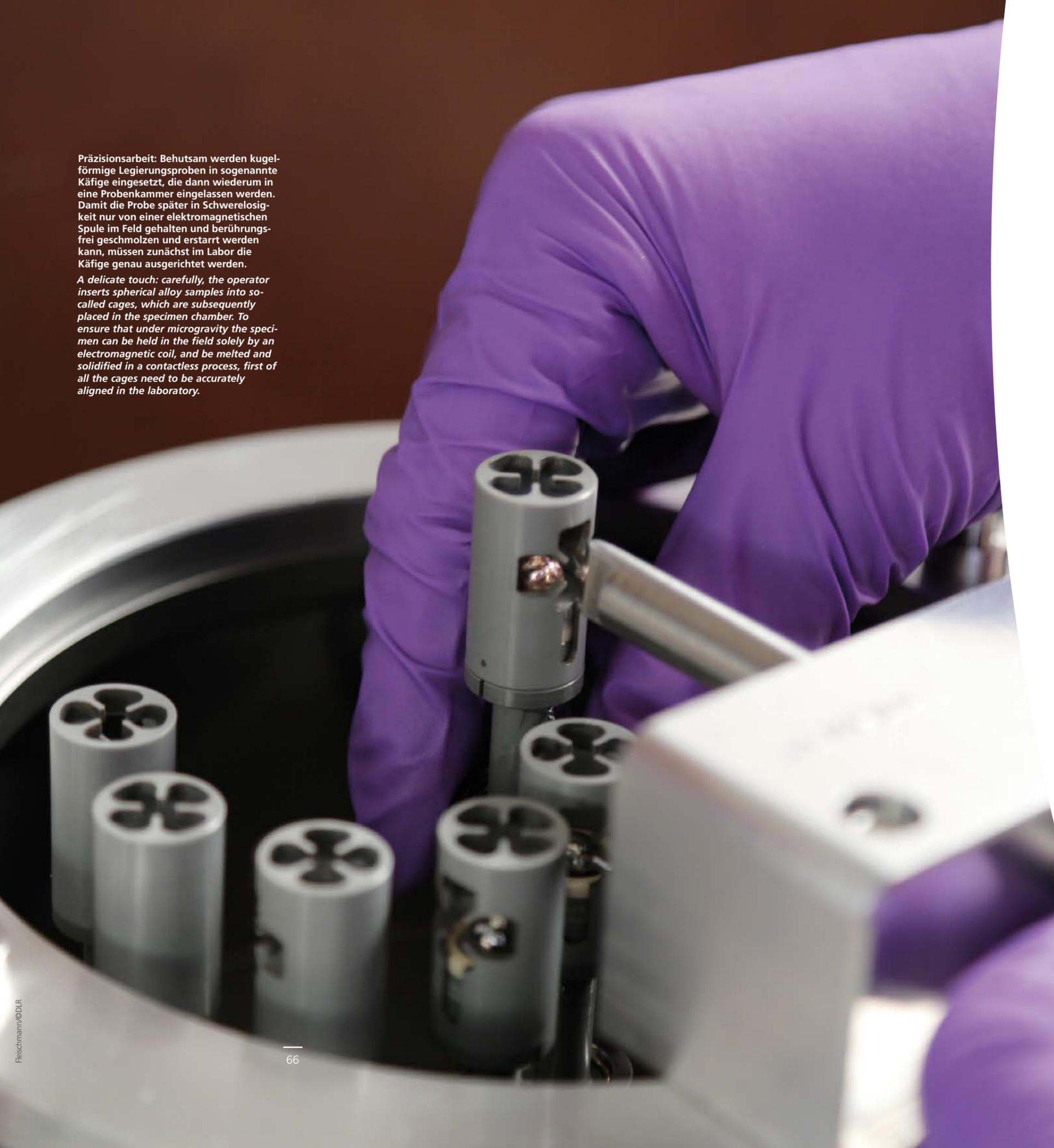
Präzisionsarbeit: Behutsam werden kugelförmige Legierungsproben in sogenannte Käfige eingesetzt, die dann wiederum in eine Probenkammer eingelassen werden. Damit die Probe später in Schwerelosigkeit nur von einer elektromagnetischen Spule im Feld gehalten und berührungsfrei geschmolzen und erstarrt werden kann, müssen zunächst im Labor die Käfige genau ausgerichtet werden.
