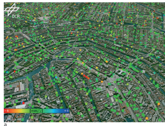
Ergebnis der Deformationsschätzung als Overlay (Überlagerungs-Schicht, einblendbare Zusatz-Information) für Google Earth®. An einzelnen Gebäuden sind deutliche Senkungen erkennbar
