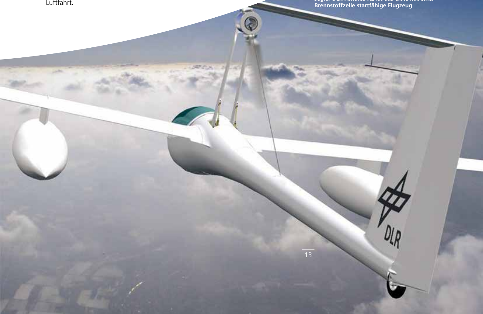
Fliegen mit der Brennstoffzelle: Der Motorsegler DLR-Antares H2 ist das erste mit einer Brennstoffzelle startfähige Flugzeug
