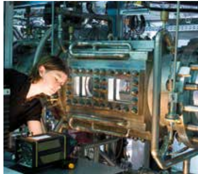
Eine gläserne Brennkammer bietet Einblick in die Verbrennung einer Gasturbine
