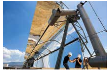
Spiegel im Test: Qualitätsuntersuchungen auf der Plataforma Solar in Almería (Südspanien)
