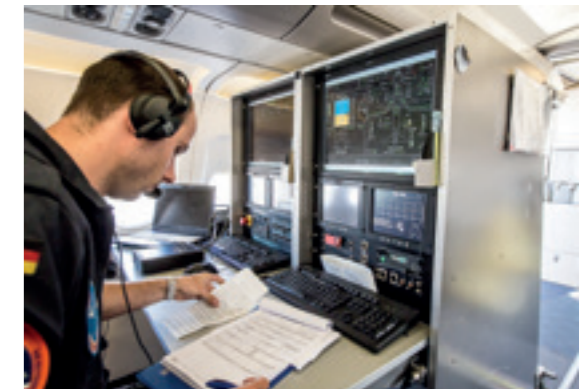
Die Basismessanlage in der ATRA-Kabine. Hier laufen die Flugversuchsdaten zusammen.
