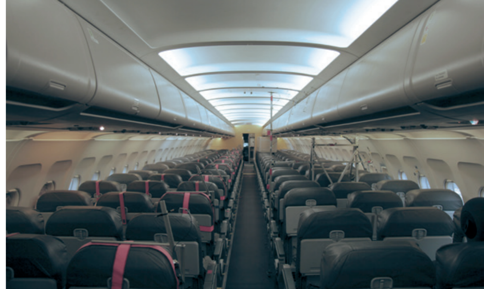
Messektion der mit stationären Mikrofonen instrumentierten Kabine. Akustische Trennung vom übrigen Teil der Kabine mittels Schaumtrennwand.
