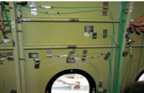
Installation von Beschleunigungsaufnehmern an freigelegter Außenhaut der Flugzeugstruktur des ATRA
