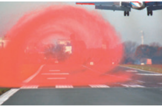
Sichtbar gemachte Wirbelschleppe im Flugversuch
