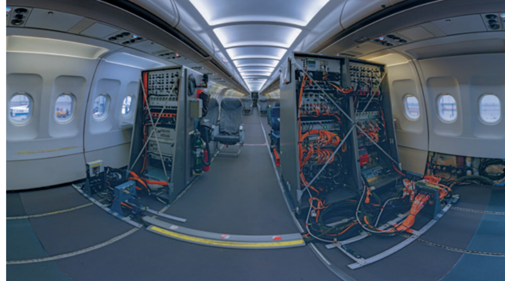
Panoramablick in die Flugzeugkabine: Die vorderen Reihen des ATRA wurden durch die Basismessanlage ersetzt und ermöglichen die unterschiedlichsten Forschungen und Missionen
