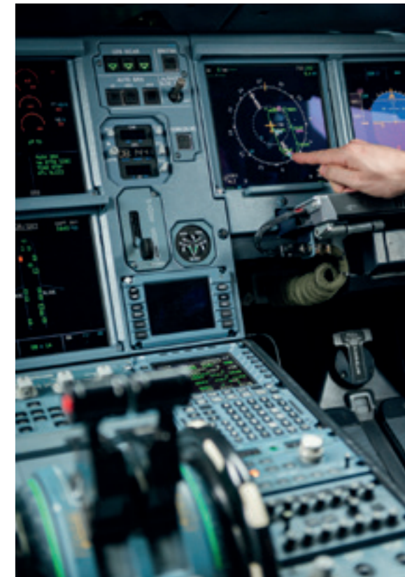
Mit Hilfe von Satellitennavigation und modernsten Flugzeugsystemen lassen sich Kurven mit festen Radien zwischen zwei Wegpunkten exakt planen und so gekrümmte Landeanflüge hochpräzise fliegen
