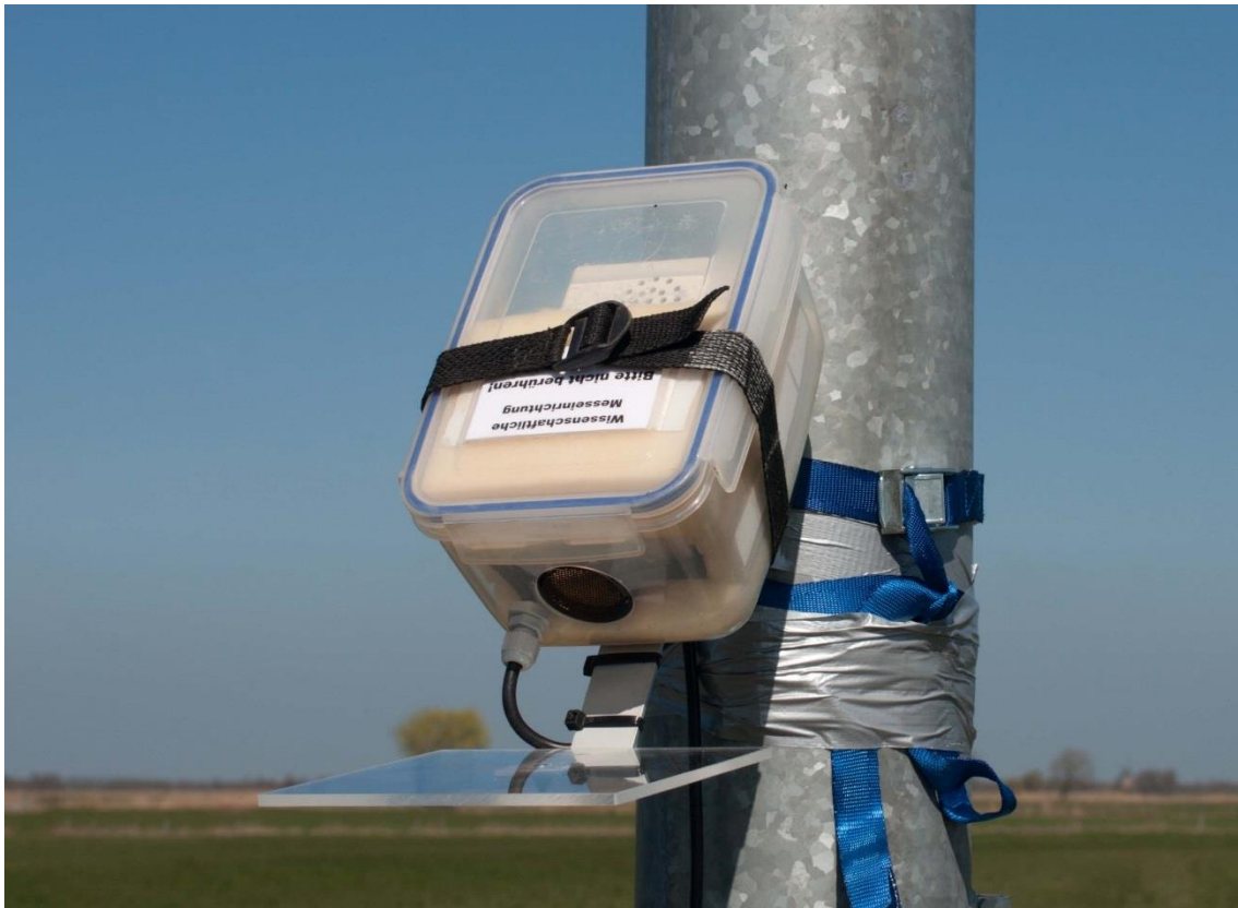
Abbildung 2: Anabat am Mast einer KWEA. Zum Schutz vor der Witterung ist das Gerät in eine wasserdichte Box montiert. Unterhalb des Mikrofons befindet sich die Reflektorplatte.
