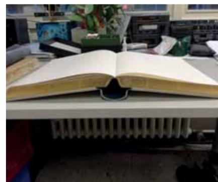
**7** Die Sprungrückentechnik lässt den Buchblock beim Öffnen hochspringen, so dass sich die Seiten flach aufschlagen lassen, was das Beschriften der Seiten von Rand zu Rand ermöglicht.
