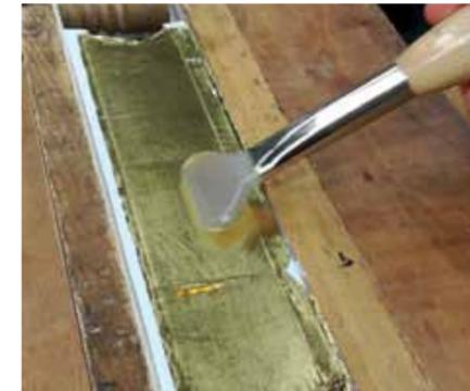
**5** Das wird mit einem Glättzahn, ein Achat am Stiel, bewerkstelligt. Nach der ersten Schicht wird später eine weitere, eine zweite Goldschicht aufgetragen. Mit einem leicht gewachsenen Tuch wird die Goldauflage am Ende unempfindlich gemacht.
