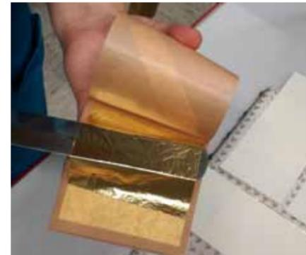
**3** Blattgold ist so dünn, dass allein das Abheben eines Blattes aus dem Blattgold-Büchlein und anschließend das ebene Aufbringen auf den Schnitt große Erfahrung und Geschicklichkeit voraussetzt. Mit dem Vergoldemesser wird das Gold auf das Vergoldekissen gelegt und zugeschnitten. Bevor das Blattgoldstück mit einem Papierstreifen wieder aufgenommen werden kann, zieht die Vergolderin den Papierstreifen über ihre Stirn. So geht ein wenig Fett auf das Papier über (wieder wie im Mittelalter).
