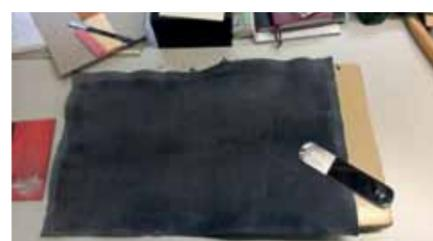
**8** Jetzt wird das Ziegenleder vorbereitet. Es bedarf eines Spezialmessers, mit dem man den Rand des Leders so dünn schärft, dass es am Rand des Deckels nach innen eingeschlagen werden kann, ohne dick aufzutragen.
