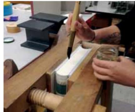
**2** Der gerundete und fertig hinterklebte Buchblock wird in einer Handpresse fest zusammengepresst. Die Oberfläche des Kopfschnittes wird jetzt extrem glatt geschmirgelt. Dann wird Eiweißgrund, das ist wasser- verdünntes Eiweiß, auf den Schnitt aufgetragen. Der Klebstoff mutet mittelalterlich an, hat sich aber für das Zusammenspiel von Gold und Papier über Jahrhunderte bewährt.
