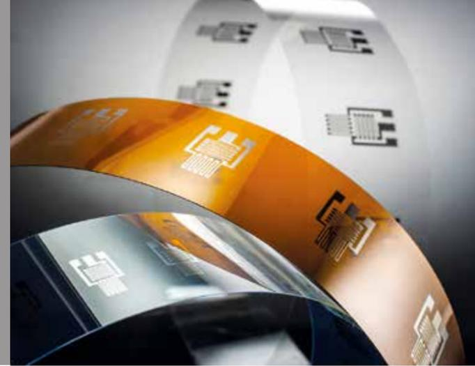
Gedruckte und laserfunktionalisierte Dehnungsmesssensoren auf Polymerfolien.
