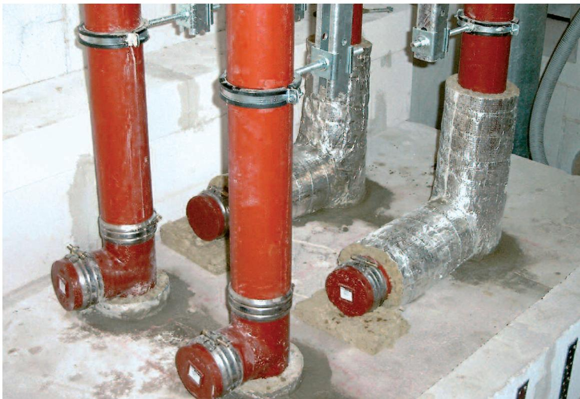
Foto „Gusseiserne Abflussrohre beim orientierenden Brandversuch bei der DMT in Dortmund – Brandsicherheit auch von oben nach unten“
