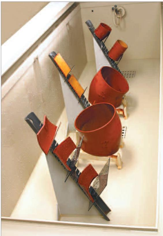
Erhöhte chemische Beständigkeit der Innenbeschichtungen von gusseisernen Abflussrohren und Formstücken zur Ableitung aggressiver Abwässer (KML / MLK) nach Tabelle 3-1 aus RAL-GZ 698, Ausgabe Oktober 2014
