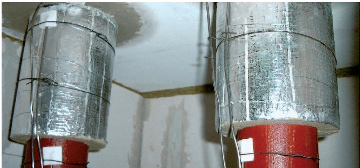
Foto „Gusseiserne Abflussrohre beim orientierenden Brandversuch bei der DMT in Dortmund – Brandsicherheit auch von oben nach unten“
