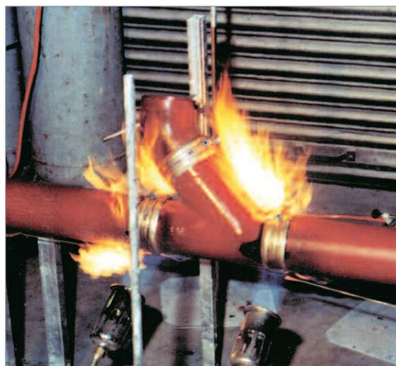
Bild „Flammprüfung über 90 Minuten des lose gelagerten Prüfstranges“
