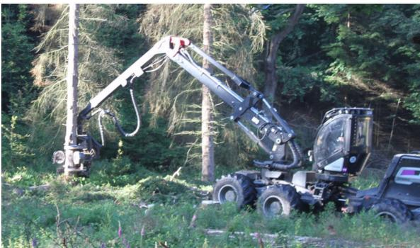
Von der äußeren Erscheinung gibt es kaum Unterschiede zu den normalen Harvestern, acht Räder, Kran mit Harvesterkopf, Fahrerkabine, Antriebseinheit unter einer sehr langen Motorhaube – fertig. Allerdings liegt der Unterschied in der verbauten Technik. Solche Maschinen besitzen ebenfalls einen Dieselmotor und dazu in Reihe geschaltet ist ein E-Motor,
