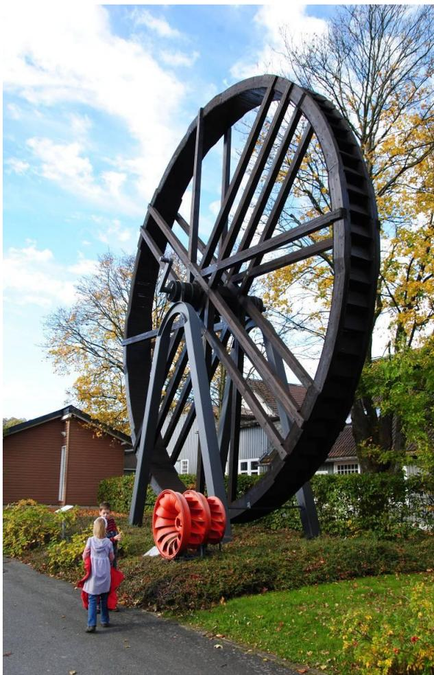
Rekonstruktion eines Kunstrades, wie es um 1700 auf dem Oberharz im Einsatz war. Mit einem Schaufelkranz mit 80 Schaufeln für eine Drehrichtung zum Antrieb der Pumpen.
