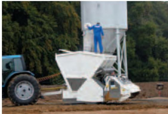
Befüllen eines Streufahrzeuges zur Bodenverbesserung mit Kalk
