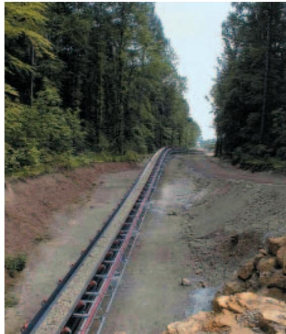
Das gebrochene Material wird zur Weiterverarbeitung mit einer Bandanlage transportiert
