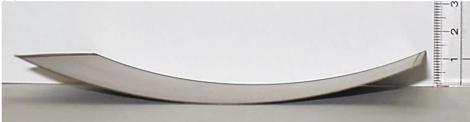
Abbildung 65: Substrate mit A-, B- und C-Ni/YSZ- Anodenschichten gesintert bei jeweils 1200°C, 3 h, H<sub>2</sub> (a.) ohne Beschwerung, (b.) mit Randbeschwerung
