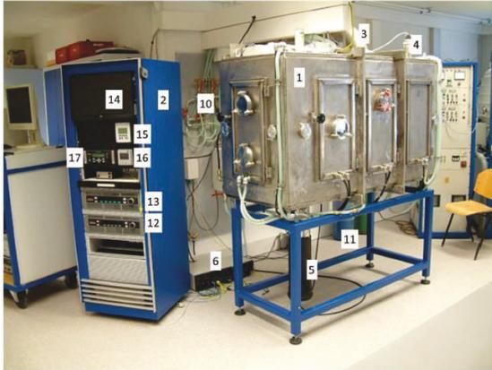
Abbildung 28: Pilotanlage zur Elektrolytbeschichtung über einen GFS-Prozess aus [63]
