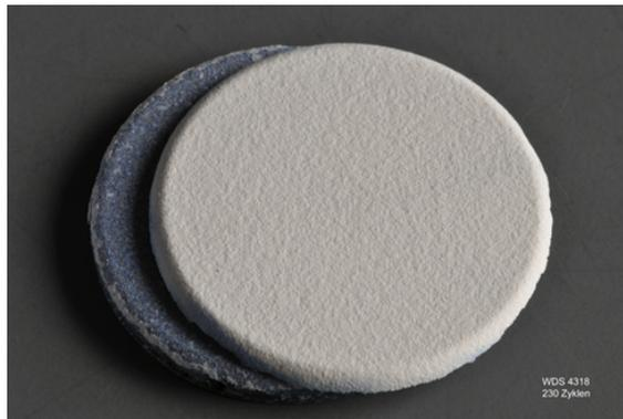
**Abbildung 6.16:** YSZ Wärmedämmschichtsystem mit 10 % ODS-Haftvermittlerschicht auf ERBO 1 Substrat und mit Amdry 995 Materialbasis nach Ofenzyklrierung bei 1100 °C nach 230 Zyklen bei 2 h heizen 15 min kühlen (WDS4318 CV036)
