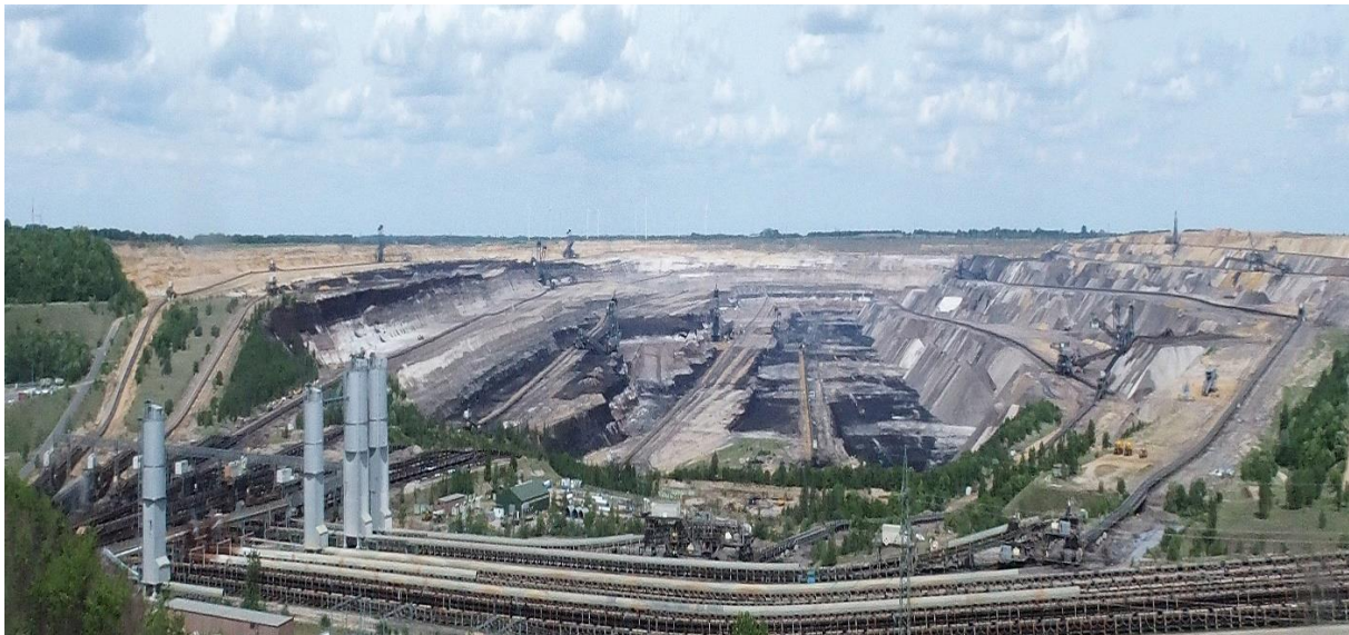
Bild 6a: Ein Kunstwerk: der Tagebau Garzweiler in Realität (links: Abraum- und Kohlegewinnung, rechts: Verkipfung und Wiedernutzbarmachung/Rekultivierung), im Vordergrund die Förderanlagen.
