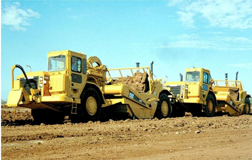
Bild 34: Schürfzüge bei den Erdbauarbeiten für das neue Kraftwerk in Frimmersdorf<sup>54</sup>
