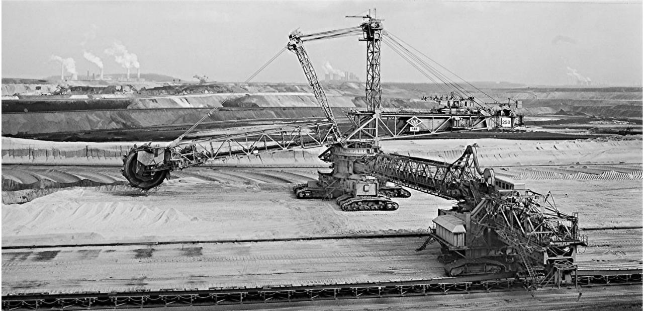
Bild 29: Schaufelradbagger 258 II, Garzweiler 1991 (© by Claudia Fahrenkemper)
