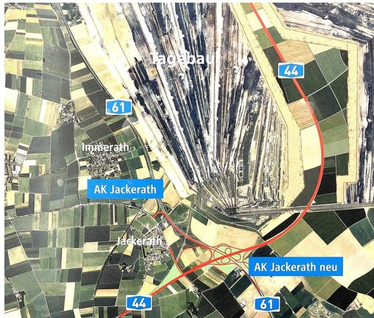
Bild 66: Die neue Autobahn A 44 auf einem dafür aufgeschütteten Damm im ausgekohlten östlichen Bereich des Tagebaus Garzweiler<sup>83</sup>
