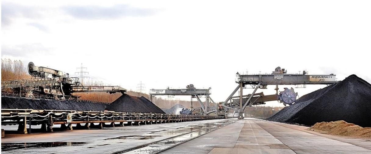
Bild 73: Kohlebunker. Hier wird die im Tagebau Garzweiler II gewonnene Kohle eingelagert und vergleichmäßigiert. Sie wird von zwei schaufelradbaggerähnlichen Aufnahmegerten in Braunkohlewaggons (Fassungsvermögen 100 t) verladen und von hier aus in Zügen über die Nord-Süd Bahn zu den Kraftwerken in Neurath und Niederaußem transportiert
