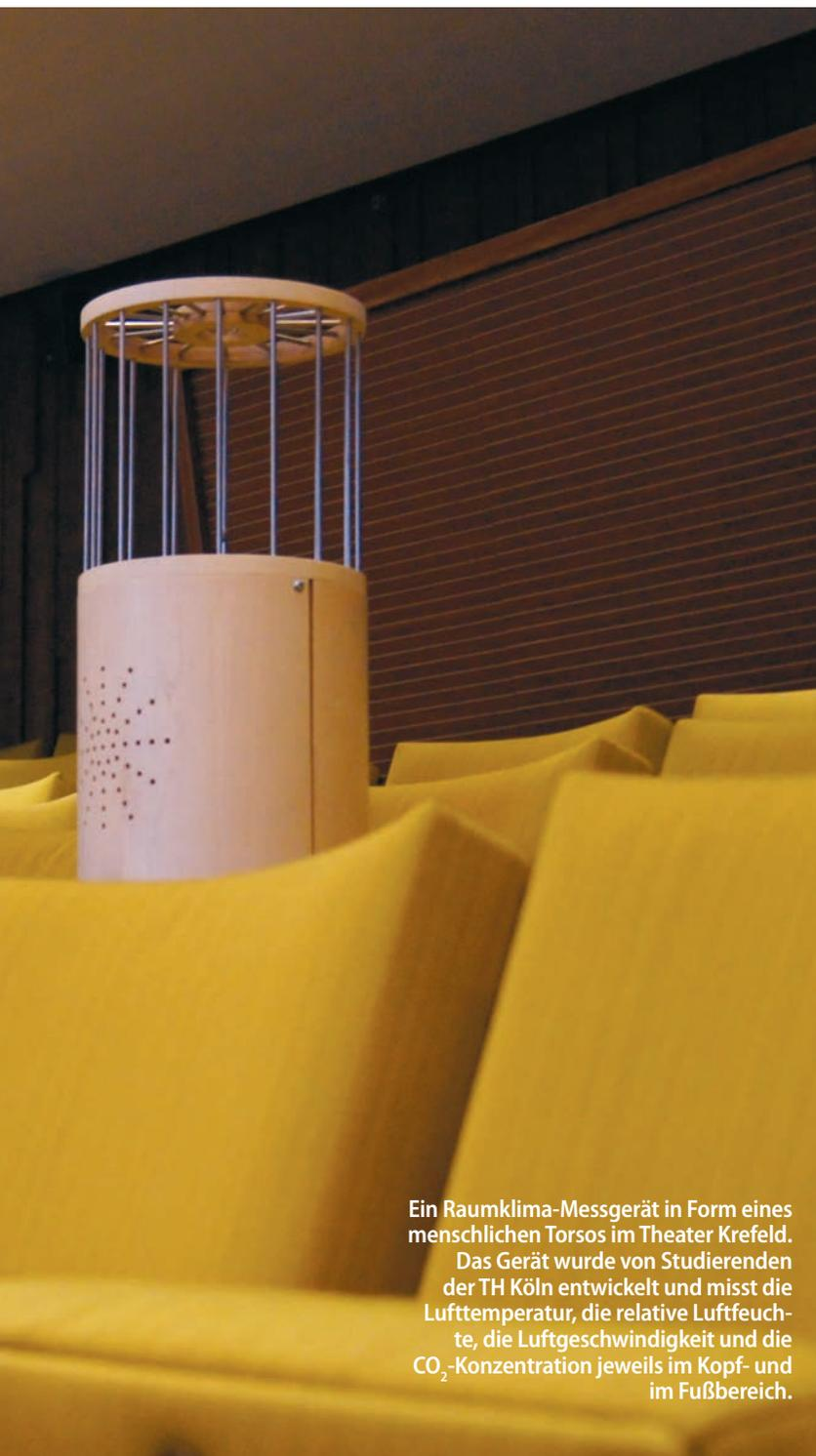
Ein Raumklima-Messgerät in Form eines menschlichen Torsos im Theater Krefeld. Das Gerät wurde von Studierenden der TH Köln entwickelt und misst die Lufttemperatur, die relative Luftfeuchte, die Luftgeschwindigkeit und die CO<sub>2</sub>-Konzentration jeweils im Kopf- und im Fußbereich.
