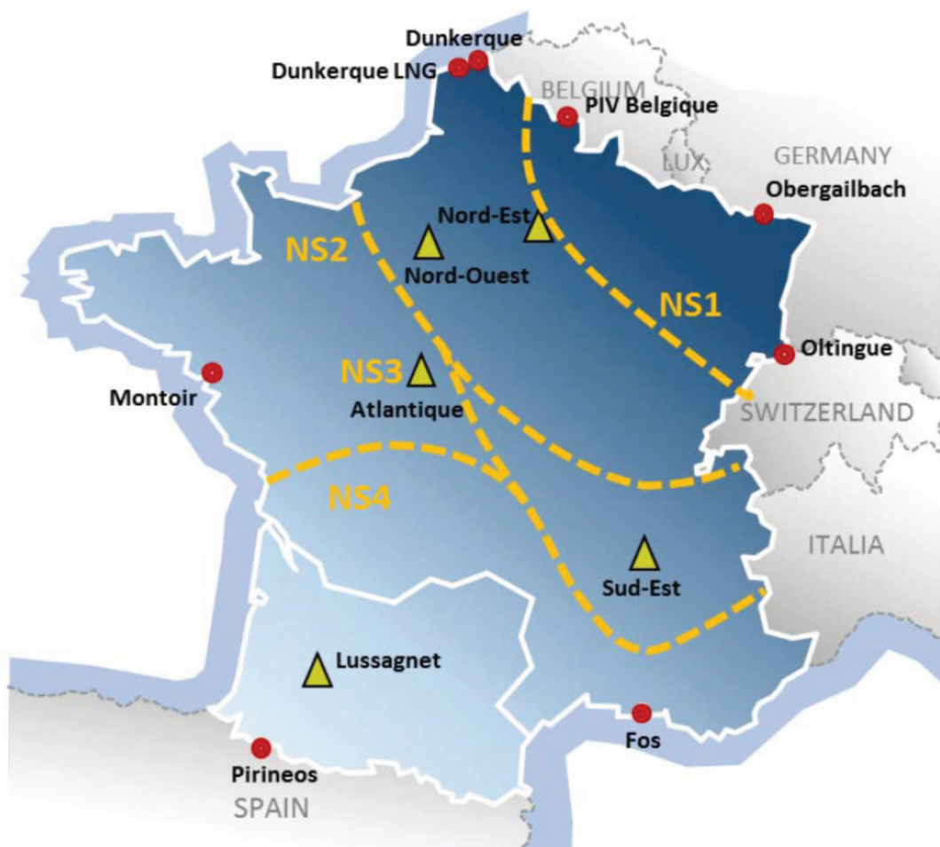
Grphe 9: Principales limites opérationnelles susceptibles d'être observées sur le réseau de transport lorsque les fournisseurs cherchent à maximiser les injections de gaz naturel depuis le nord-est de la France (20)
