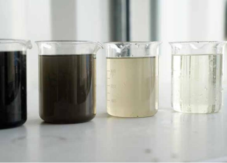
**Ansicht der Qualitäten vom Input über Ablauf Anaerobstufe, Ablauf biologische Reinigung und Ablauf Bodenfilter**
