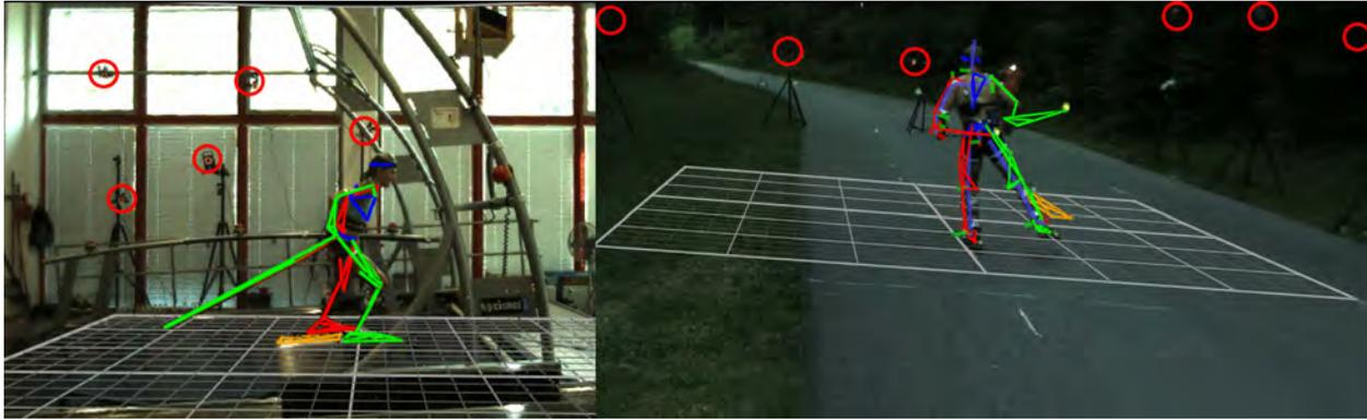
Abb. 1: Indoor (links) und Outdoor (rechts) Messung mit Überlagerung von Videobild und biomechanischer Modellierung auf Basis von 3d-Bewegungsanalyse (rote Kreise).
