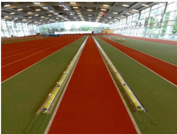
Abb. 1. OptojumpNext Messgerät mit einer Länge von 50 m
